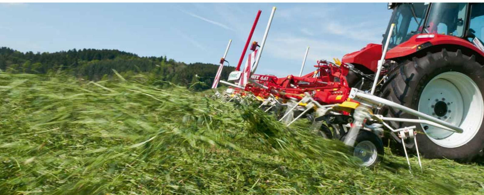
Nos faneuses à la technique éprouvée se distinguent par une parfaite adaptation au sol. Elles vous permettent de faner tout en douceur et de conserver un fourrage propre. Les roues larges, en combinaison avec la roue de jauge fixée à la tête d'attelage, améliorent nettement le suivi du terrain. Le haut niveau de finition garantit une très grande longévité.
