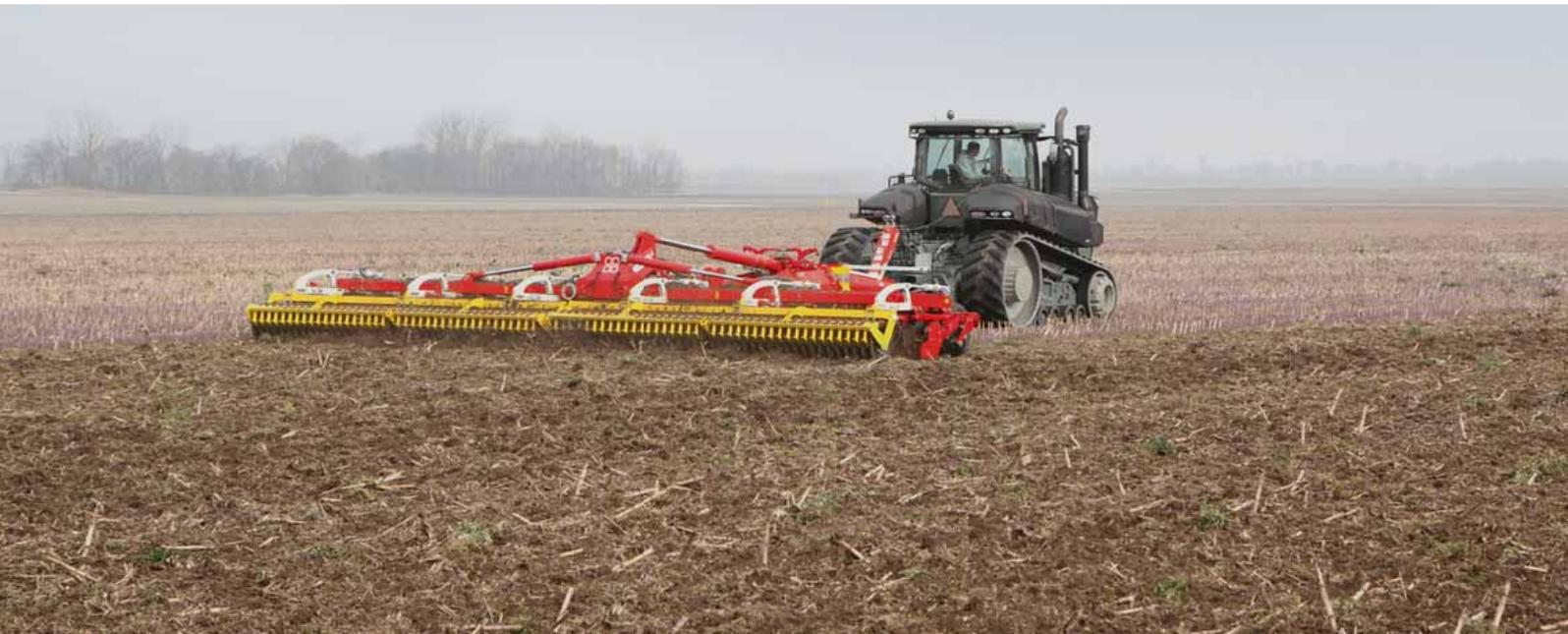
Les déchaumeurs à disques TERRADISC ont été conçus pour le déchaumage et la préparation du lit de semence. Des machines compactes pour un travail superficiel et un mélange intensif. La conception compacte ainsi que la position agressive des disques assurent une bonne pénétration et un bon enfouissement des résidus végétaux.
