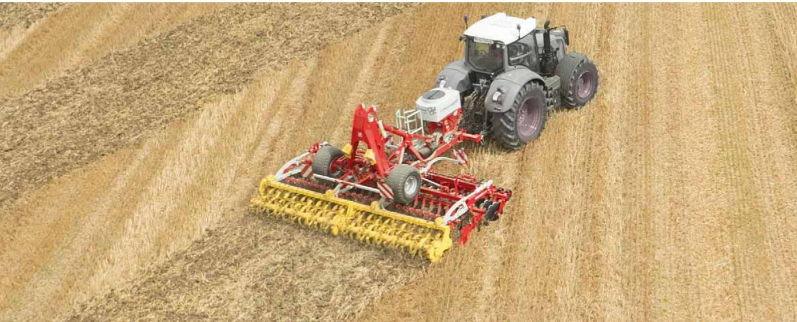
El sistema de siembra de precisión esparcida TEGOSEM combina el laboreo del suelo y la siembra de frutos en una sola pasada, ahorrando tiempo y gastos. La TEGOSEM se puede combinar con las gradas de discos TERRADISC, así como con los cultivadores SYNKRO de PÖTTINGER. Es posible usar la sembradora con máquinas suspendidas y arrastradas.
