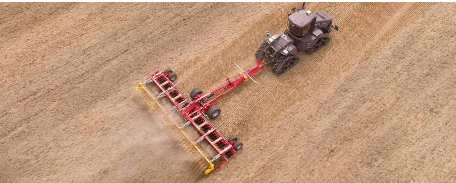
Las gradas de discos TERRADISC se desarrollaron para el volcado de rastrojos y para la preparación general del terreno para la siembra. La construcción compacta, así como la posición agresiva de los discos, aportan una entrada segura y una buena mezcla de los residuos de cosecha.
