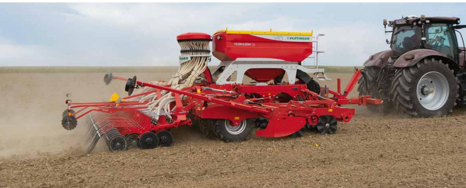
Los discos ondulados WAVE DISC están libres de mantenimiento, tienen un diámetro de 510 mm y están disponibles con una distancia entre hileras de 12,5 cm o 16,7 cm. La profundidad de trabajo es ajustable como en el sistema WAVE DISC con progresión continua hidráulica. El sistema WAVE DISC de PÖTTINGER es ideal para condiciones de suelo complicadas, que requieren un laboreo del suelo reducido. Los discos ondulados WAVE DISC están disponible para todas las sembradoras de mínimo laboreo TERRASEM.
