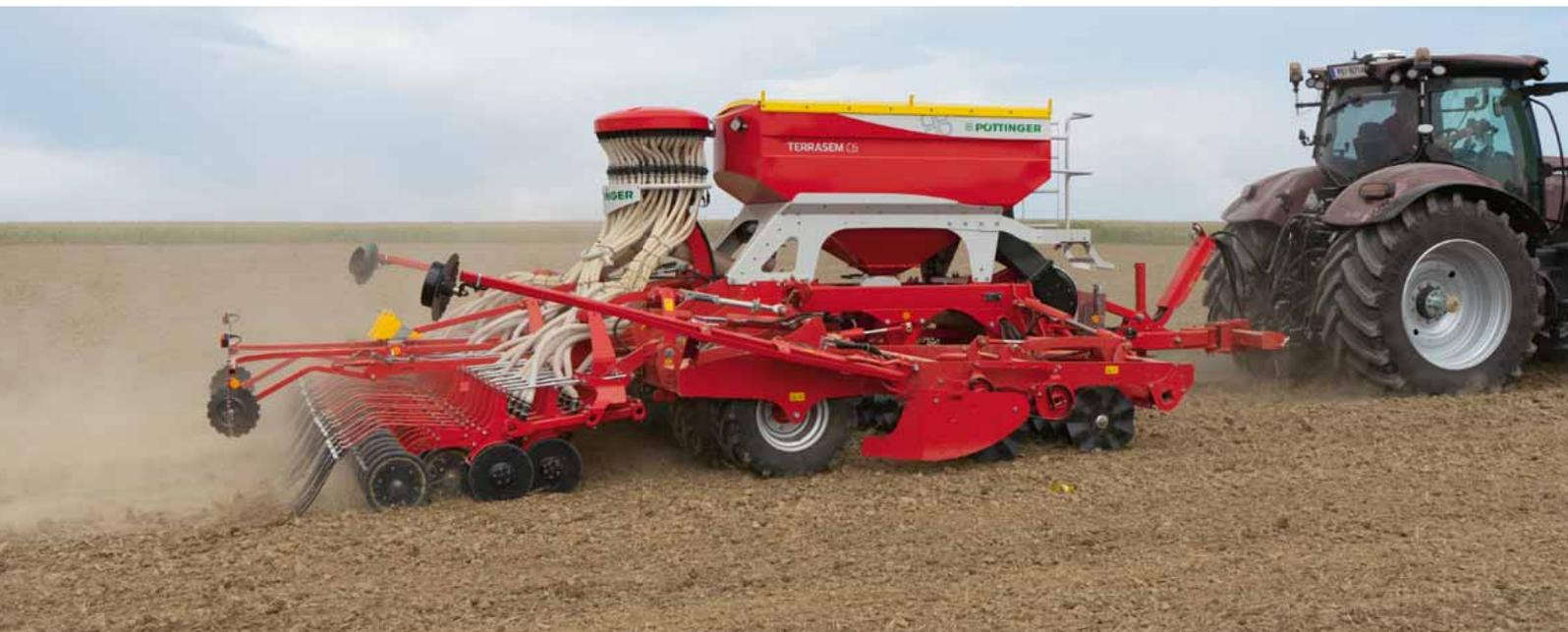
Les disques gaufrés sans entretien WAVE DISC ont un diamètre de 510 mm et sont proposés avec des entre-rangs de 12,5 cm ou 16,7 cm. La profondeur de travail est réglable en continu hydrauliquement. Le principe du WAVE DISC de PÖTTINGER est idéalement adapté aux conditions de travail difficiles, nécessitant un travail du sol restreint. Les disques gaufrés WAVE DISC sont disponibles sur tous les modèles de semoir TERRASEM.
