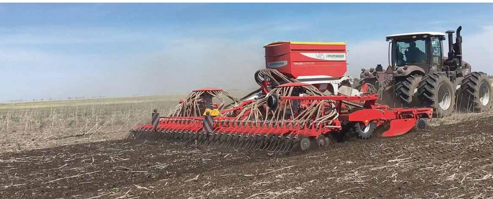
Le concept de semoir universel TERRASEM de PÖTTINGER allie la préparation du lit de semence, son rappuyage et le semis en une seule machine. Le déchaumeur à disques performant, le rouleau à pneus unique ainsi que la rampe de semis exceptionnelle assurent un résultat optimal.
