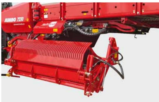
Le molle a compressione e i bilancieri del dispositivo di sicurezza brevettato dei coltelli si trovano in posizione sicura. Ciò riduce notevolmente l'imbrattamento del supporto dei coltelli. Durante ogni fuoriuscita del gruppo di taglio la protezione contro la polvere ripulisce gli spazi tra i coltelli.
