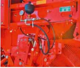
**Compensazione idraulica per pick-up**
