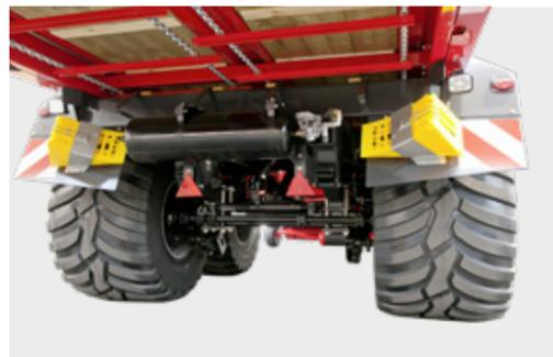
**Steigendes Ladevolumen und hohe Transportgeschwindigkeiten verlangen nach robusten und bodenschonenden Fahrwerken.** PÖTTINGER hat sich eingehend mit dieser Thematik beschäftigt. Hochwertige Tandemachsen und Reifen mit großer Aufstandsfläche sind die Antwort.
