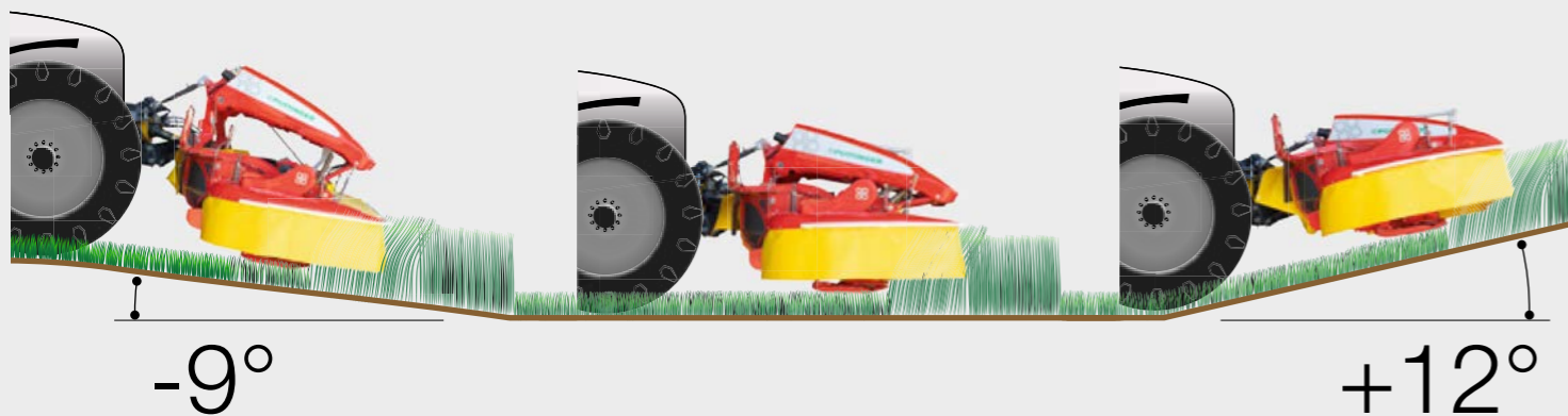
NOVACAT ALPHA MOTION MASTER: -7° / +13° NOVACAT ALPHA MOTION PRO: -9° / +12°
