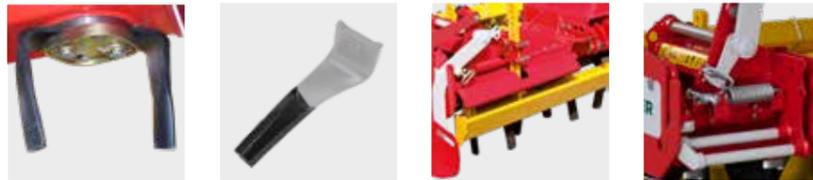
**Zinken-Schnellwechsel**      **DURASTAR Zinken**      **Front-Prallschiene**      **Seitenschilder gefedert**
