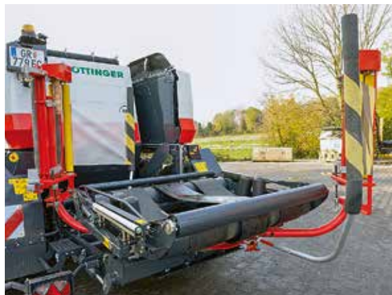
Обмотувач працював без збоїв. Паралелограмне регулювання забезпечує можливість обмотування рулонів різного діаметра.
