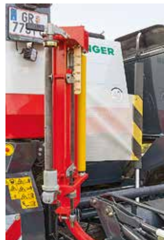
Обмотувач працював без збоїв. Паралелограмне регулювання забезпечує можливість обмотування рулонів різного діаметра.
