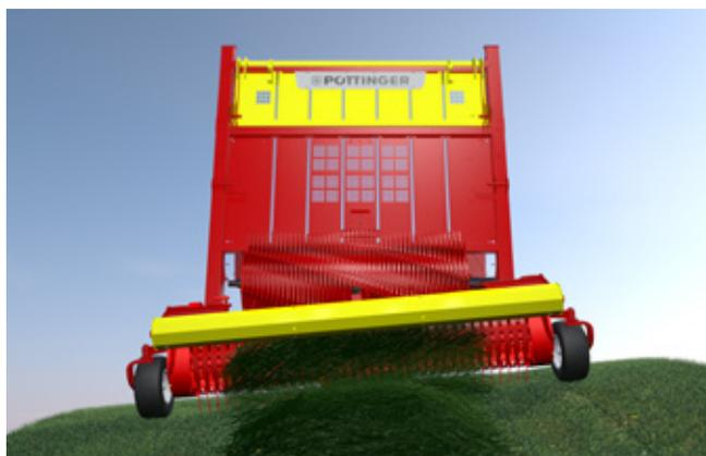
Pick-up con adattamento perfetto al terreno per una presenza ridotta di ceneri grezze nel foraggio
