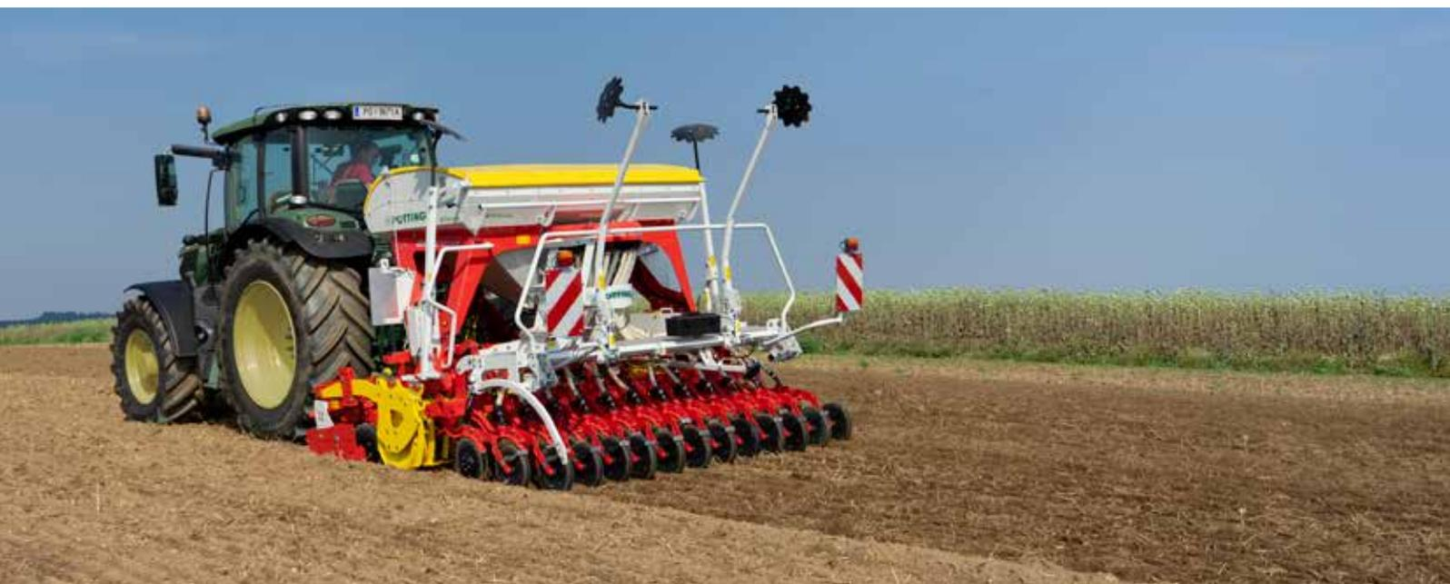
Le semoir AEROSEM est un concept unique pour le semis de céréales et le semis monograine du maïs, avec possibilité d'incorporation simultanée de l'engrais. La distribution précise et universelle et les éléments de semis performants garantissent une dépose précise de la semence.
