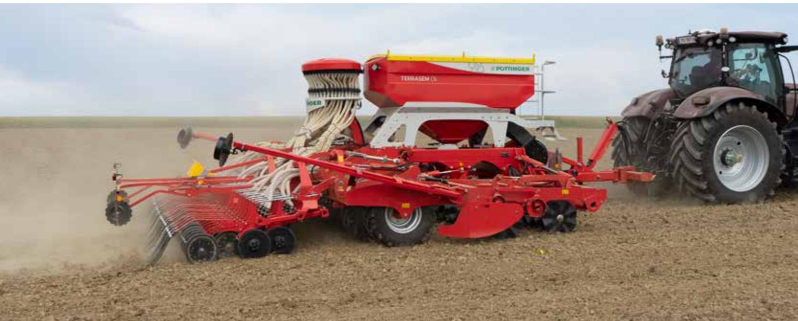
Les disques gaufrés sans entretien WAVE DISC ont un diamètre de 510 mm et sont proposés avec des entre-rangs de 12,5 cm ou 16,7 cm. La profondeur de travail est réglable en continu hydrauliquement. Le principe du WAVE DISC de PÖTTINGER est idéalement adapté aux conditions de travail difficiles, nécessitant un travail du sol restreint. Les WAVE DISC sont proposés sur tous les modèles de TERRASEM.
