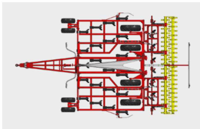
Les dents du déchaumeur TERRIA sont disposées de manière symétrique par rapport au milieu de la machine. Un travail homogène du sol est ainsi garanti, même à faible profondeur.
