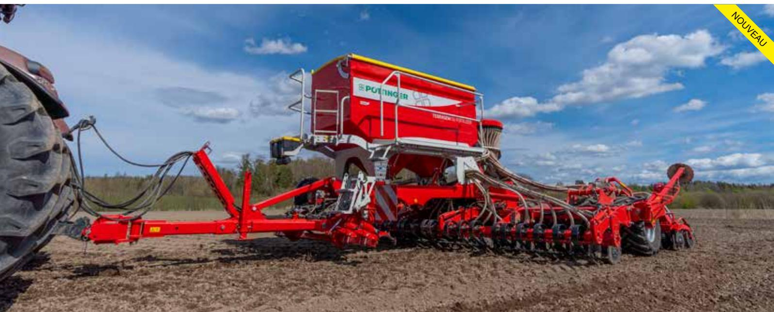
Les nouveaux TERRASEM CLASSIC sans disques déchaumeurs offrent une solution performante sur les grandes surfaces avec moins de puissance consommée. Pour cela, le lit de semence doit être bien préparé - cette préparation ayant lieu avant le semis. Qualité de semis parfaite grâce à la dépose de la semence dans un lit bien rappuyé grâce au rouleau packer à pneu unique sur le marché.
