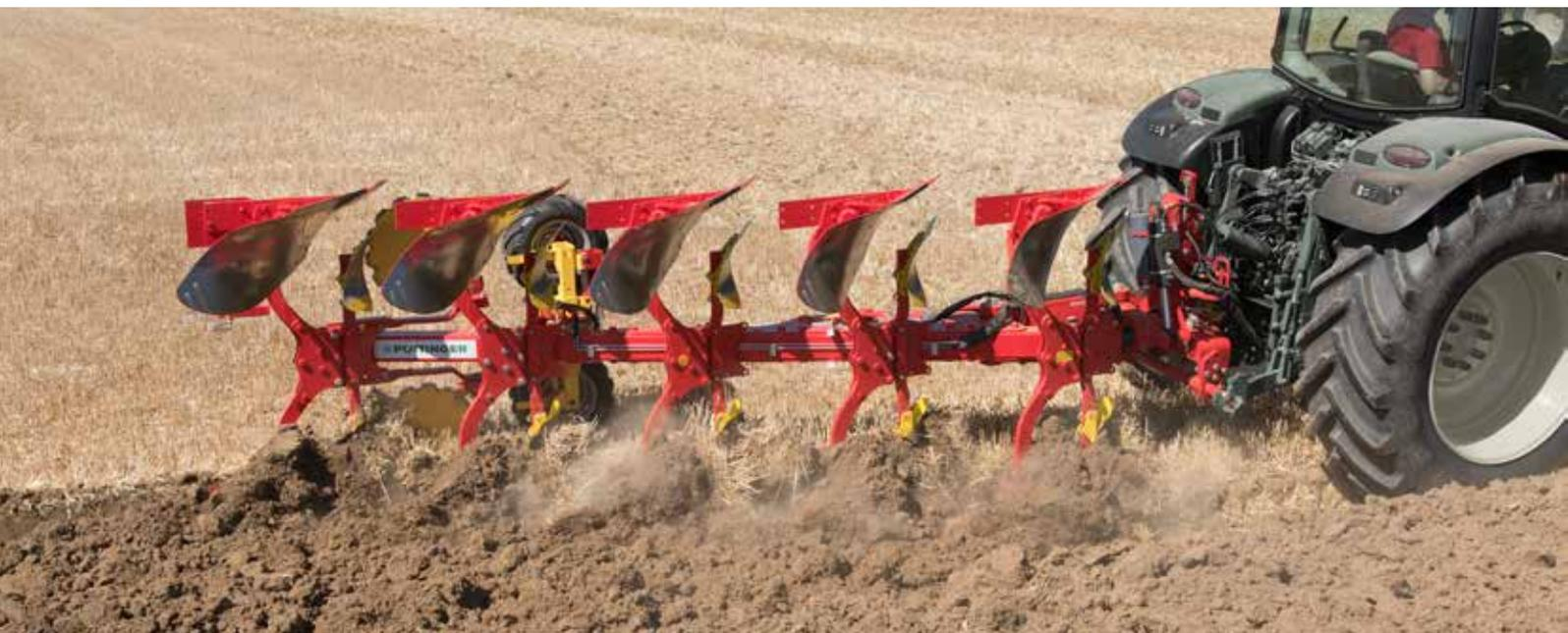
La construcción robusta e inteligente de los arados PÖTTINGER garantiza una distribución óptima de fuerza y estabilidad en el área de carga del bastidor. El centro único de ajuste de PÖTTINGER permite la adaptación simple y óptima a todos los tipos de suelo y condiciones de uso.
