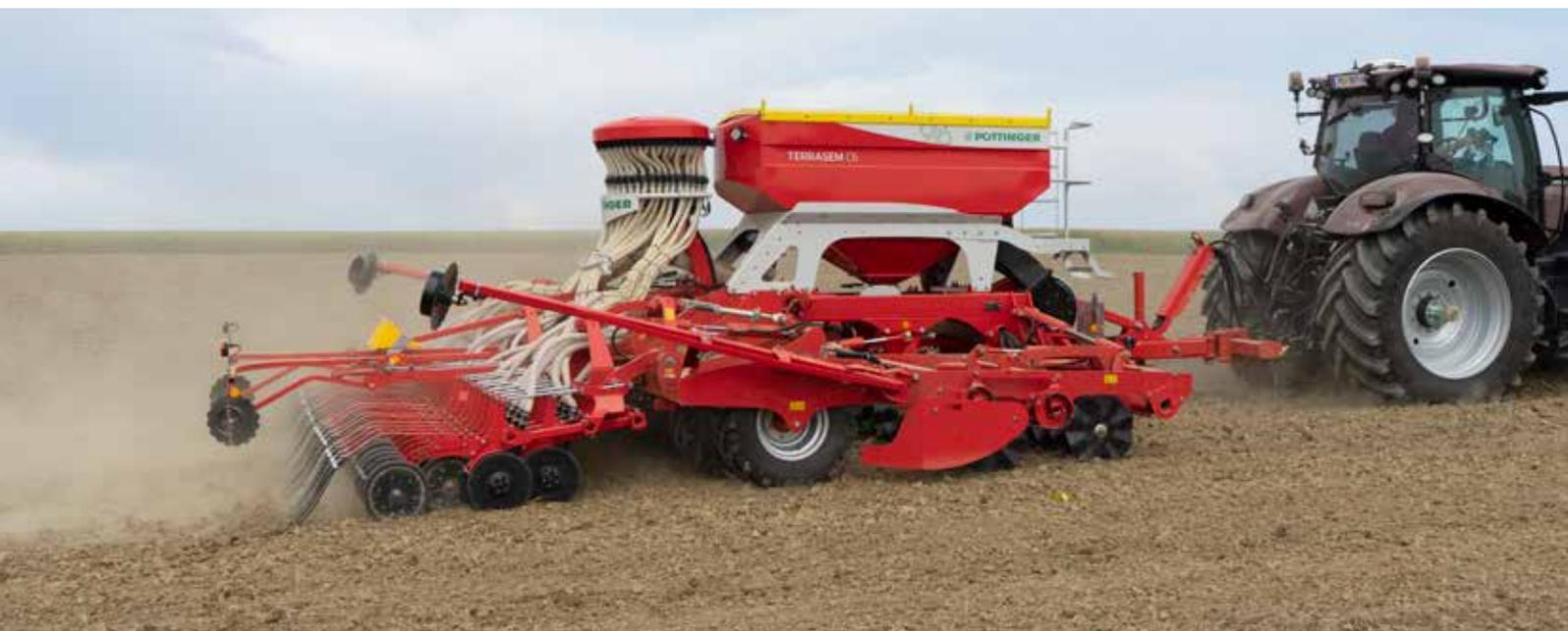
Los discos ondulados WAVE DISC están libres de mantenimiento, tienen un diámetro de 510 mm y están disponibles con una distancia entre hileras de 12,5 cm o 16,7 cm. La profundidad de trabajo es ajustable como en el sistema WAVE DISC con progresión continua hidráulica. El sistema WAVE DISC de PÖTTINGER es ideal para condiciones de suelo difíciles, que requieren un laboreo de suelo reducido. Los discos ondulados WAVE DISC están disponibles para todas las sembradoras de mínimo laboreo TERRASEM.
