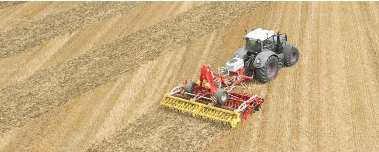
El sistema de siembra de precisión esparcida TEGOSEM combina el laboreo del suelo y la siembra de frutos en una sola pasada, ahorrando tiempo y gastos. La TEGOSEM se puede combinar con las gradas rotativas LION, preparadores de siembra FOX, gradas rápidas TERRADISC y cultivadores SYNKRO. Es posible usar la sembradora con máquinas suspendidas y arrastradas.
