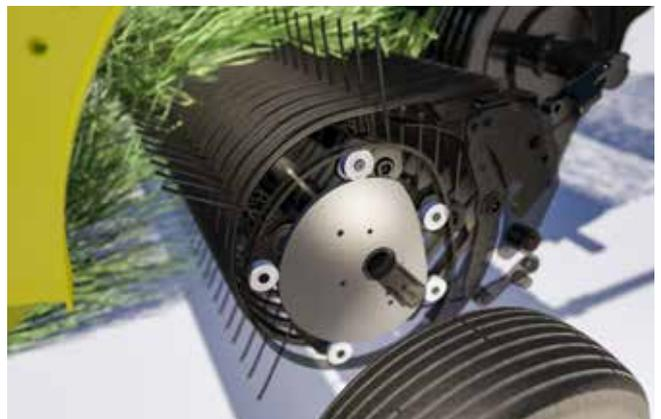
El pick up PÖTTINGER dispone de un control de levas de acero en ambos lados.
