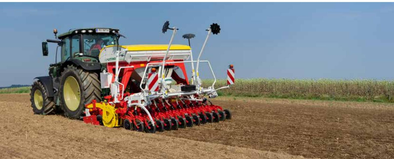
L'eccezionale tecnologia della seminatrice AEROSEM di PÖTTINGER combina la semina di cereali e di mais. Il preciso sistema di dosaggio universale ed il perfetto sistema di coltri garantiscono un deposito preciso della semente.
