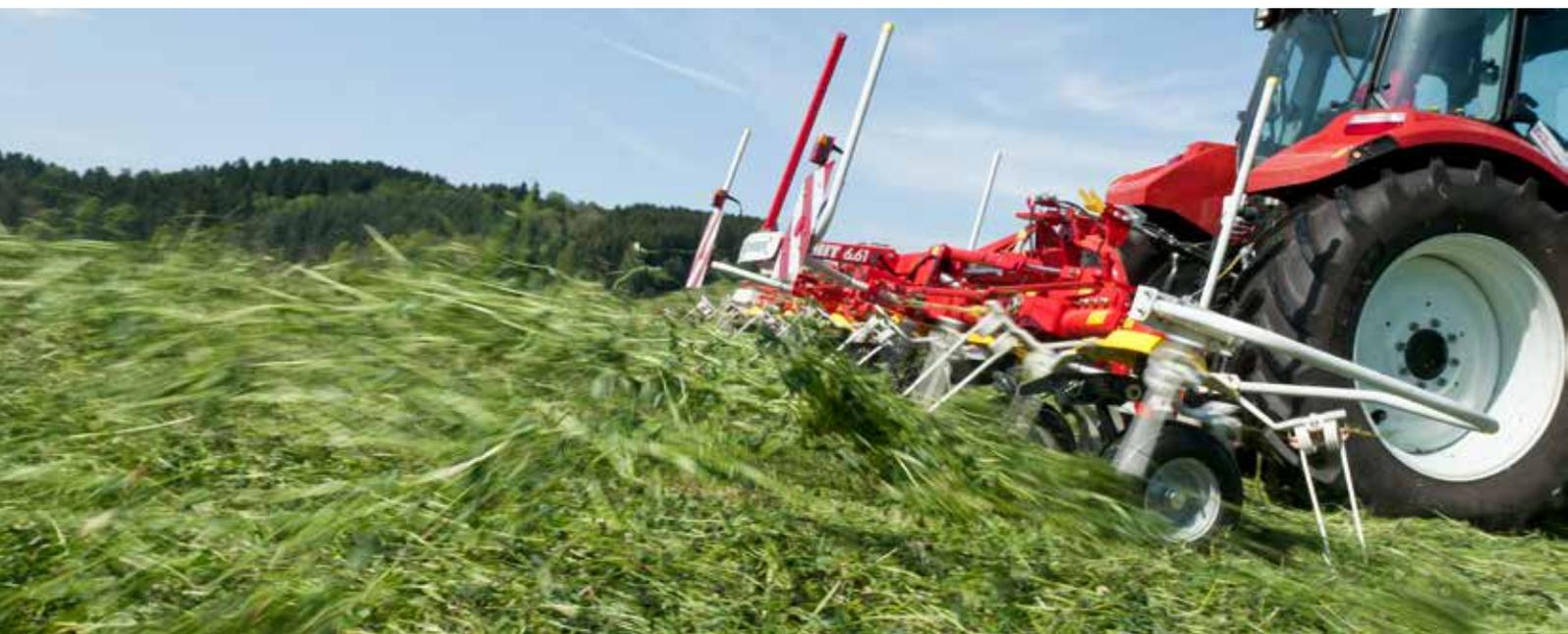
I nostri affermati spandivoltafieno convincono per il loro adattamento perfetto al terreno. Ciò consente un rivoltamento del foraggio senza sporco. Le ruote larghe e la ruota tastatrice MULTITAST montata sull'attacco a 3 punti migliorano notevolmente la stabilità sui pendii. L'elevata qualità di costruzione garantisce una lunga durata di vita.
