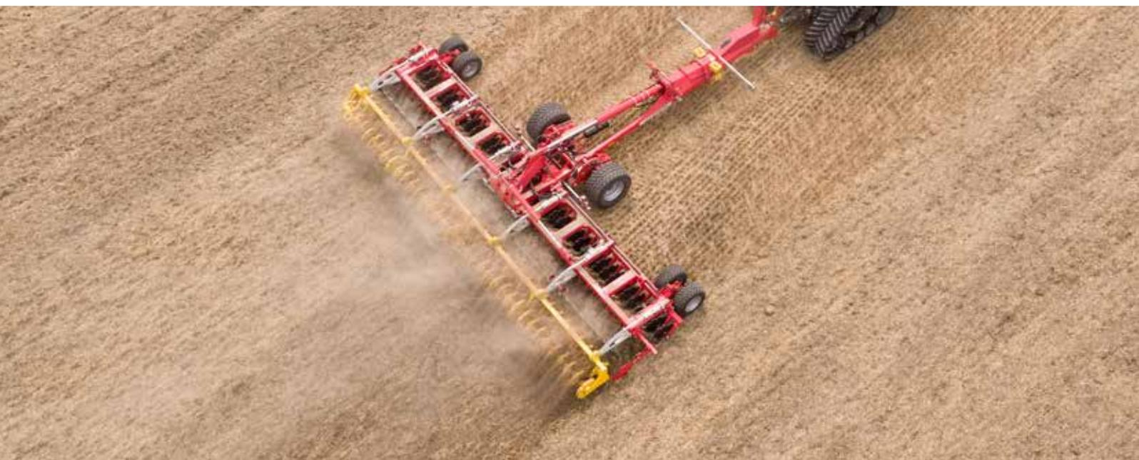
Gli erpici a dischi TERRADISC sono stati concepiti per l'abbattimento delle stoppie su grandi superfici e per la preparazione del letto di semina. La costruzione compatta e la posizione aggressiva dei dischi contribuiscono ad una penetrazione efficace e ad un buon rimescolamento dei residui colturali.
