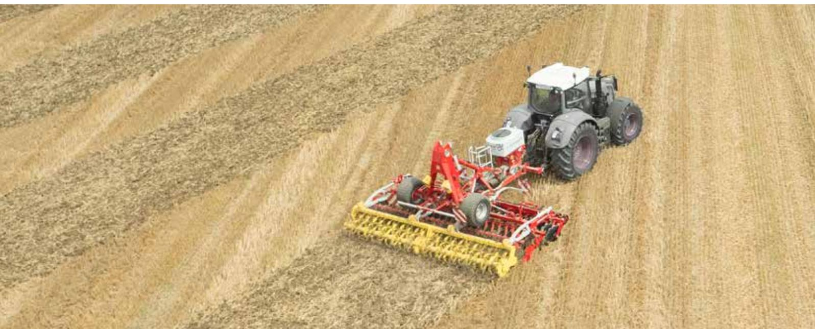
La seminatrice per colture intercalari TEGOSEM combina lavorazione del terreno e semina di colture intercalari in un'unica fase di lavoro, riducendo tempi di lavorazione e costi. TEGOSEM è combinabile sia con gli erpici rotanti LION, che con le combinate FOX, con gli erpici a dischi TERRADISC e con i coltivatori SYNKRO. L'impiego della seminatrice è possibile con macchine con attacco a 3 punti e con macchine semiportate.
