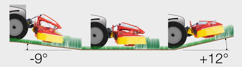
NOVACAT ALPHA MOTION MASTER: -7° / +13° NOVACAT ALPHA MOTION PRO: -9° / +12°
