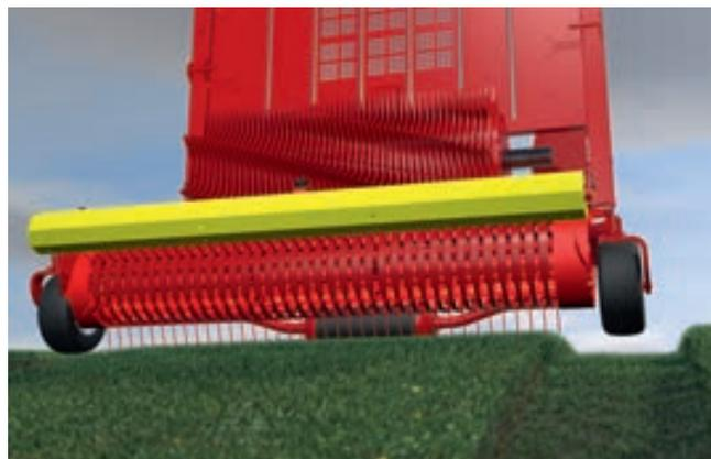
Подборщик RÖTTINGER обеспечивает значительную подбирающую способность даже при высокой скорости движения и сложных условиях сбора травяной массы. Новый дополнительный копирующий ролик расположен по центру за подборщиком. Центральное расположение предотвращает погружение в след трактора и, тем самым, гарантирует оптимальное копирование поверхности.
