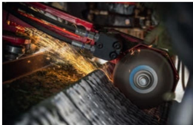
Точная и равномерная резка — это основа высокого качества сенажа. Устройство AUTOCUT обеспечивает стабильное качество нарезки в течении всего рабочего дня. Устройство для заточки ножей AUTOCUT позволяет удобно производить заточку ножей непосредственно на прицепе-подборщике.
