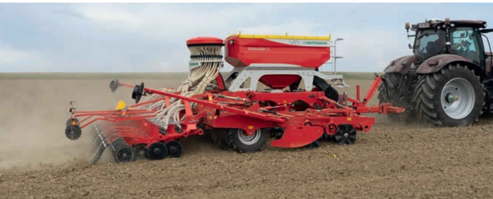
Волнистые диски WAVE DISC, не требующие технического обслуживания, имеют диаметр 510 мм и доступны с расстоянием между рядами 12,5 см и 16,7 см. С WAVE DISC также возможна бесступенчатая регулировка рабочей глубины при помощи гидравлики. Система WAVE DISC компании PÖTTINGER идеально подходит для сложных почвенных условий, которые требуют минимальной обработки поверхности почвы. Волнистые диски WAVE DISC можно приобрести ко всем сеялкам по мульче TERRASEM.
