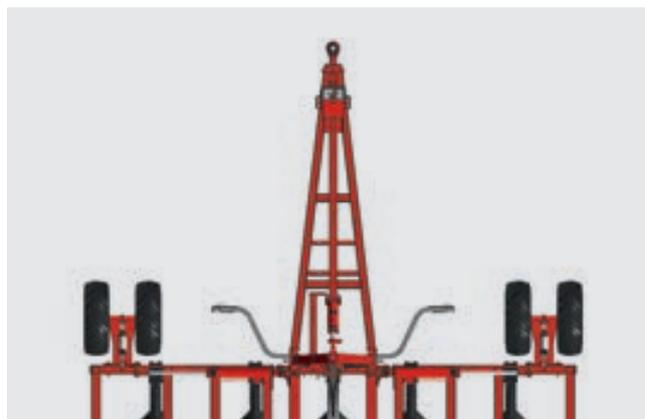
Общая длина машины уменьшена за счет размещения колес в рабочую зону, что гарантирует минимальный радиус разворота. Машина оснащена двухколесным или четырехколесным шасси в зависимости от рабочей ширины. Последний вариант обладает большой опорной поверхностью, что сводит к минимуму повреждение почвы даже при высокой собственной массе машины.
