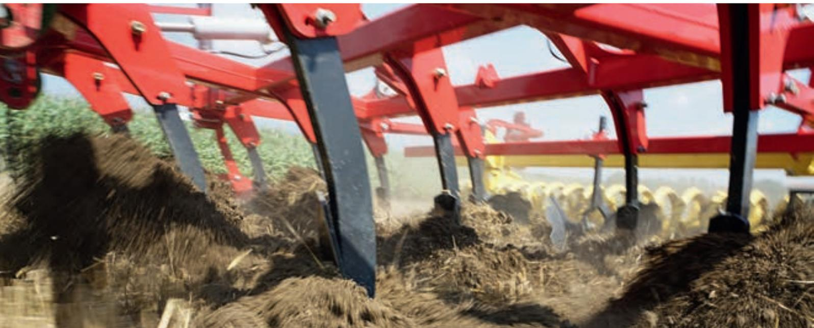
Культиваторы SYNKRO компании PÖTTINGER разработаны для своевременной обработки стерни и подходят как для поверхностной, так и для глубокой обработки почвы. При их конструировании особое внимание уделялось достижению легкости ведения и низкой требуемой мощности.
