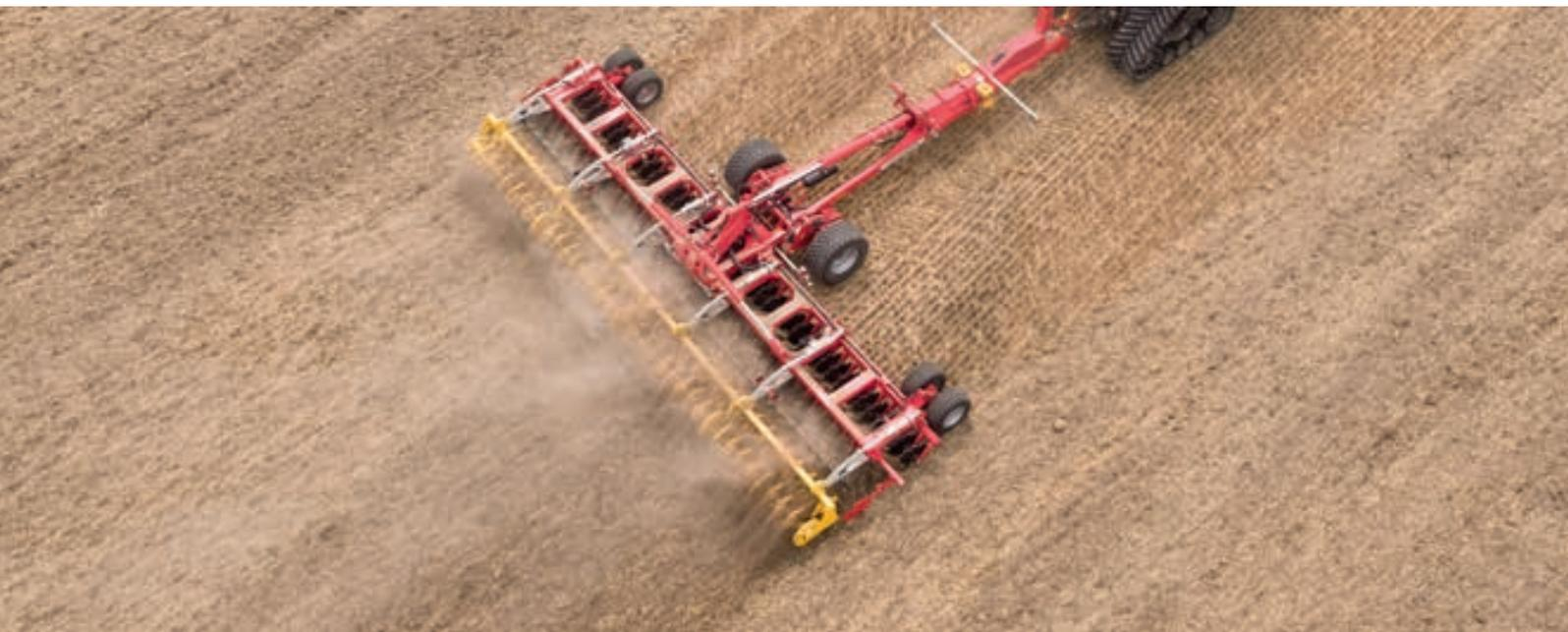
Короткобазовые дисковые бороны TERRADISC были разработаны для обработки стерни и общей предпосевной подготовки почвы. Компактная конструкция и агрессивное расположение дисков обеспечивают надежное ведение и тщательное перемешивание пожнивных остатков.
