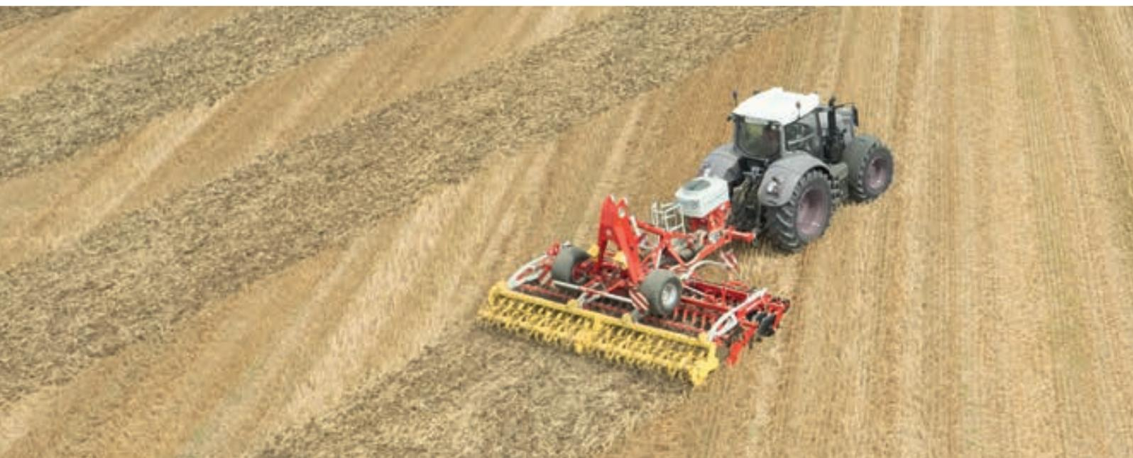
Сеялка для промежуточных культур TEGOSEM объединяет в одном рабочем шаге почвообработку и подсев трав, экономя тем самым время и деньги. TEGOSEM может работать с ротационными боронами LION, короткобазными комбинациями FOX, дисковыми боронами TERRADISC и с культиваторами SYNKRO. Сеялка может применяться на машинах с 3-точечной навеской и на прицепных моделях.
