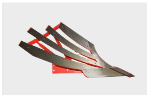
Les versoirs bénéficiant de cette cémentation se distinguent par la dureté des deux couches extérieures de 2,3 mm d'épaisseur et l'élasticité au cœur de la matière. Cette combinaison réalise un labour de qualité, même avec des terres hétérogènes et s'écoulant mal le long du versoir (terres noires cendrées).
