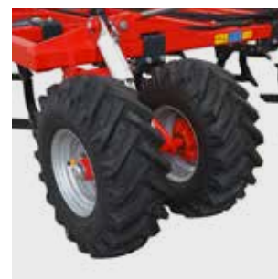
Hydraulicky ovládaná dvojitá čelní kola 11,5/80-15,3
