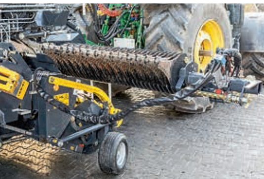
Po odblokowaniu szuflady z nożami można wysunąć w prawo.
