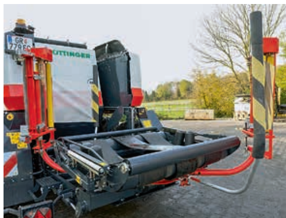
Owijarka działała bez żadnych problemów. Wystarczy przełączyć równoległobok, aby dopasować do różnych średnic.
