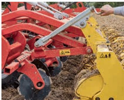
Dzięki połączeniu z wałem prowadzonym na równoległoboku, talerze wyrównujące rzadko wymagają regulacji.
