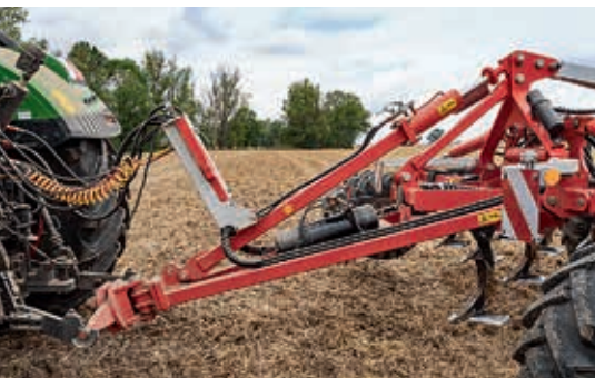
Terria może być zaczepiona na dolnych tęcznicach lub na dolnym zaczepie polowym.
