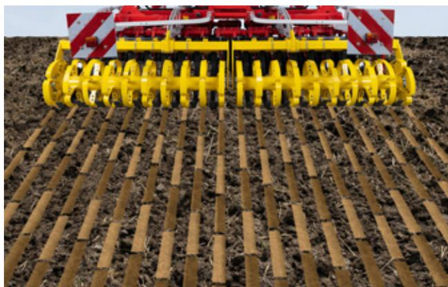
L'écartement entre les disques est de 20 cm. Des décrotoirs, montés sur lamelles de ressort, sont disposés entre les disques. Ils intensifient l'émiettement et nettoient l'espace entre les disques.
