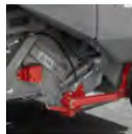
**Commande automatique du timon hydraulique AUTOTAST**
