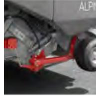
**Commande automatique du timon hydraulique AUTOTAST**
