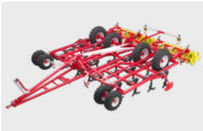
Les dents du TERRIA sont réparties de manière symétrique, « en miroir », le long de la ligne de traction. Un travail homogène du sol est ainsi garanti, même à faible profondeur. La répartition optimale des efforts permet de stabiliser la machine dans le sol, évitant ainsi toute traction latérale et garantissant une qualité de travail constante.
