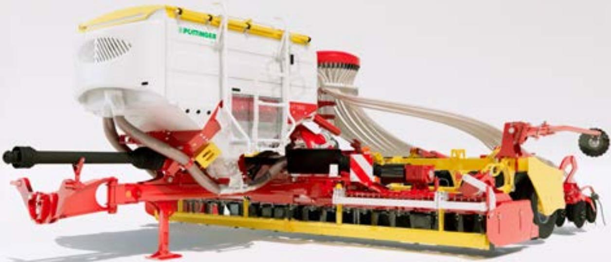
Le nouveau combiné de semis traîné AROSEM VT de PÖTTINGER avec travail du sol actif combine la préparation du lit de semence avec une herse rotative LION, le rappui avec le rouleau à bandes caoutchouc et le semis avec la rampe DUAL DISC. Ce nouveau concept a été conçu aussi bien pour les terres légères qu'extrêmement lourdes.
