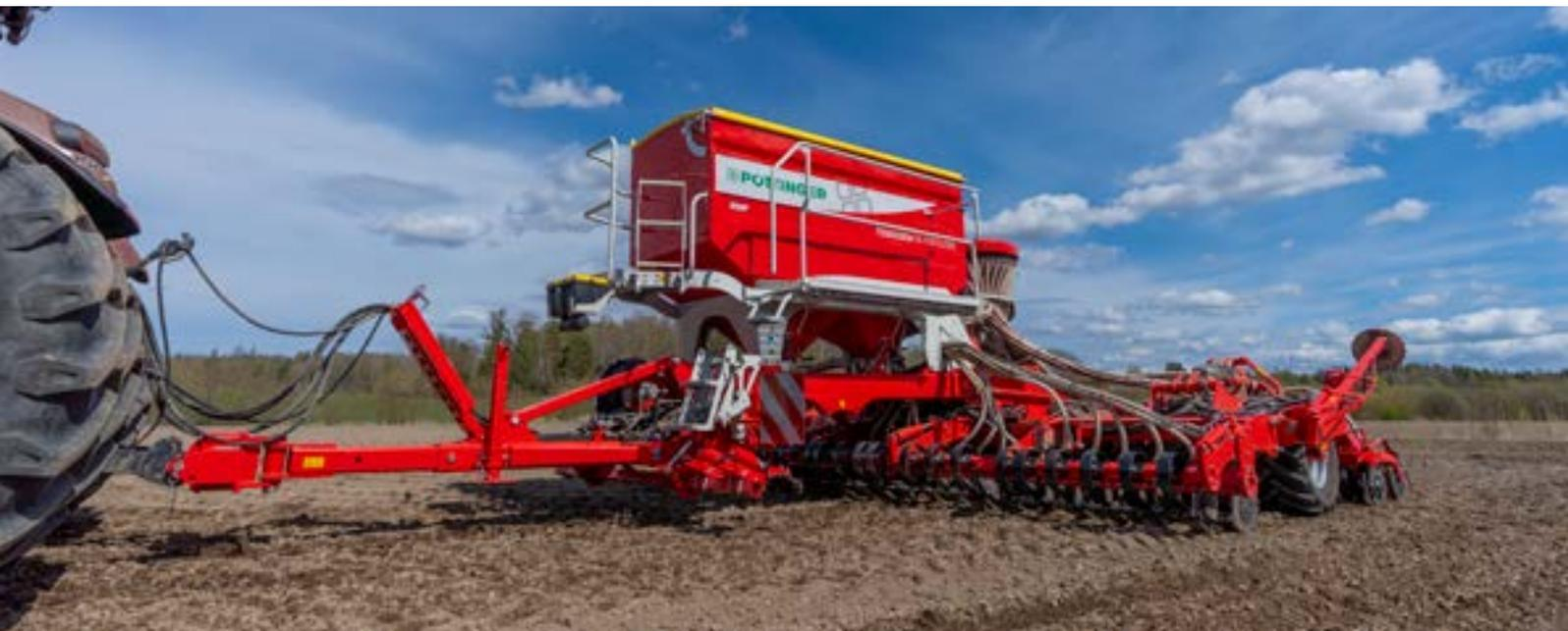
Les nouveaux TERRASEM CLASSIC sans disques déchaumeurs offrent une solution performante sur les grandes surfaces avec moins de puissance consommée. Pour cela, le lit de semence doit être bien préparé - cette préparation ayant lieu avant le semis. Grâce à l'adaptation au sol optimale et le rouleau packer à pneu unique en son genre, une dépose parfaite de la semence est réalisée dans un lit de semence parfaitement rappuyé.
