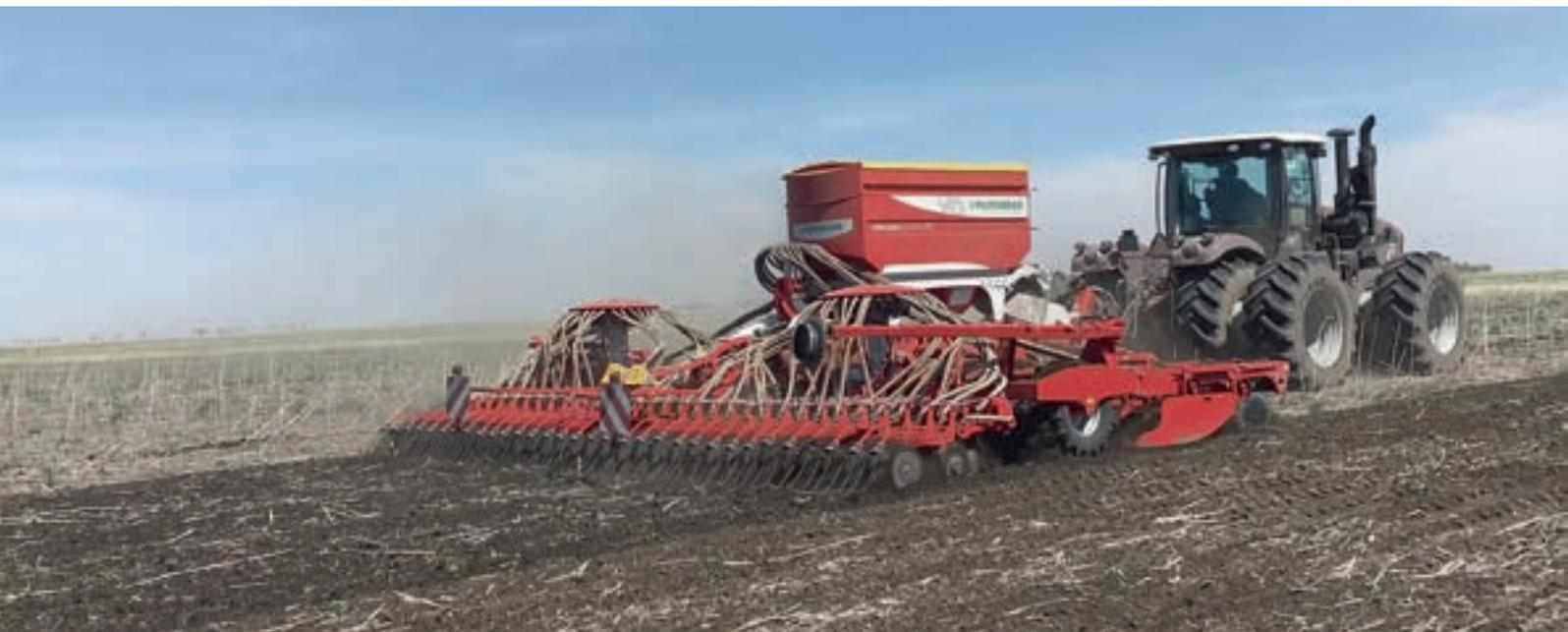
El concepto de siembra de mínimo laboreo TERRASEM de PÖTTINGER une los pasos de laboreo del suelo, compactación y siembra en una máquina. La eficiente grada de discos cortos, el compactador único, así como la perfecta sembradora, aportan un óptimo resultado de trabajo.
