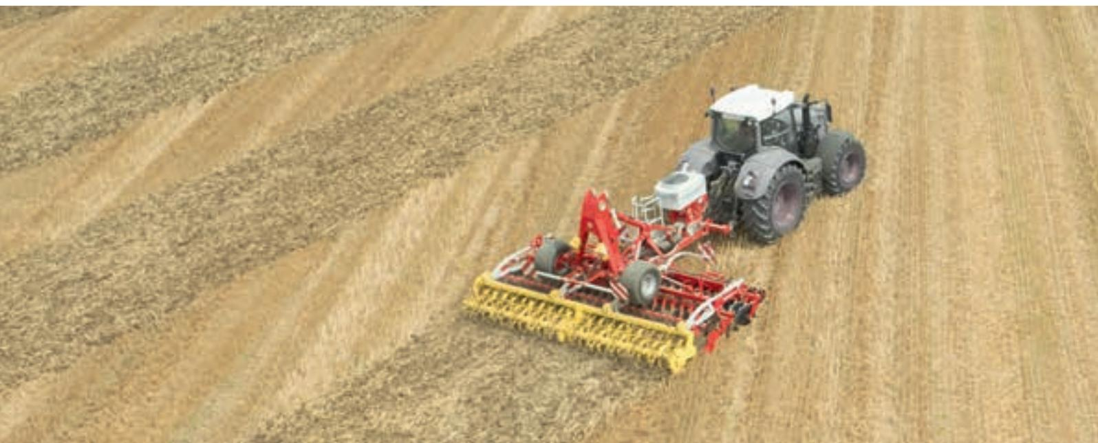
La seminatrice per colture intercalari TEGOSEM combina lavorazione del terreno e semina di colture intercalari in un'unica fase di lavoro, riducendo tempi di lavorazione e costi. TEGOSEM è combinabile sia con gli erpici rotanti LION, che con le combinate FOX, con gli erpici a dischi TERRADISC, con i coltivatori SYNKRO e con le seminatrici per semina su paccime TERRASEM. L'impiego della seminatrice è possibile con macchine con attacco a 3 punti e con macchine semiportate.
