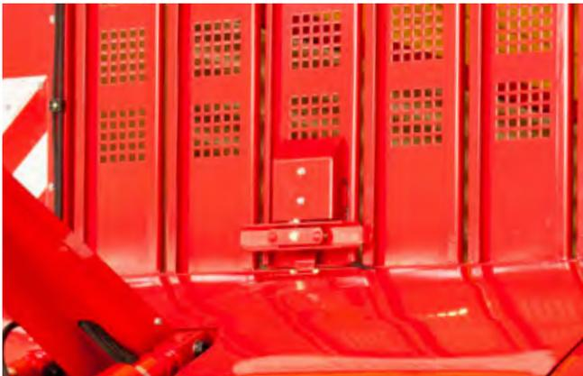
Ein Sensor misst bereits im unteren Bereich des Frontgatters den Ladedruck bei feuchtem, schwerem Gras und schaltet den Kratzboden. Dadurch wird eine Futterzerstörung durch zu hohen Druck am Laderotor verhindert. Der zweite Sensor in der Verdichtungsklappe misst den Verdichtungsgrad im Laderaum. Das Futter wird gleichmäßig verdichtet und der Laderaum dadurch optimal befüllt.
