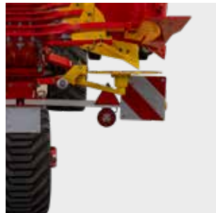
Warntafeln mit Beleuchtung
