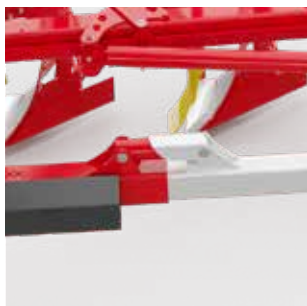
Гидравлическая настройка ширины захвата первого корпуса
