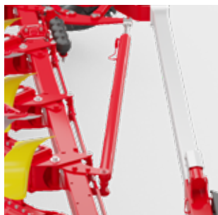
Гидравлическая настройка рабочей ширины
