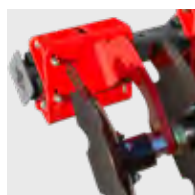
Réglage indépendant des disques dans les traces de roues
