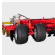
Hydrauliczne koła kopiujące (podwójne koła kopiujące) 340/55-16
