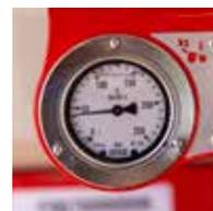
**Гидравлическая регулировка давления на сошники**
