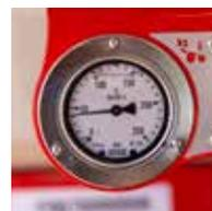
**Réglage hydraulique de la pression des éléments semeurs**
