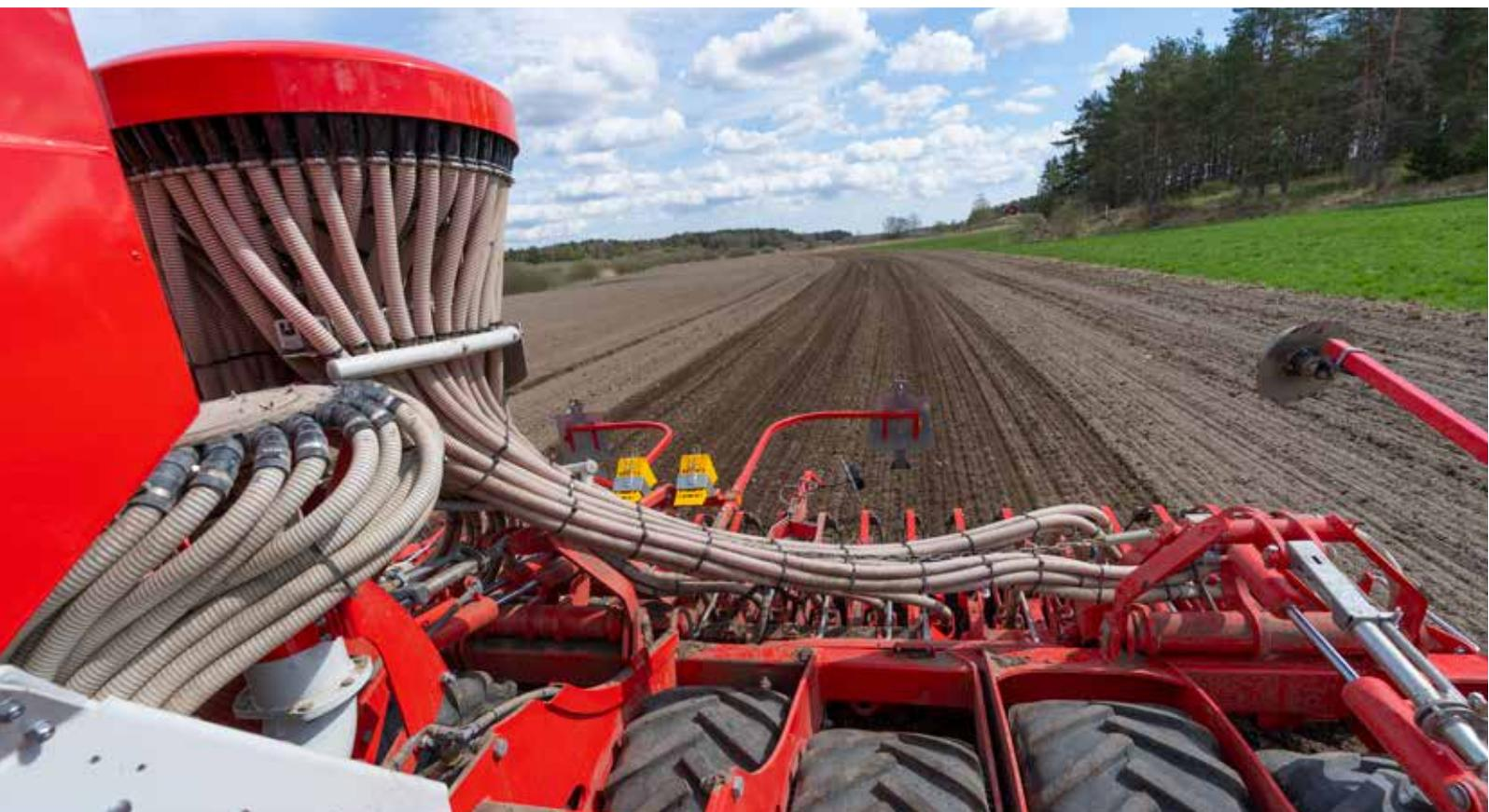
Le rouleau à pneus assure le rappuyage nécessaire avant la rampe de semis pour disposer de conditions de semis parfaites. Cette étape de rappuyage est indispensable, car la terre intensément ameublie et émiétée doit être remise en contact avec la couche inférieure humide pour permettre la remontée par capillarité de l'eau, offrant l'humidité nécessaire à la germination de la graine.
