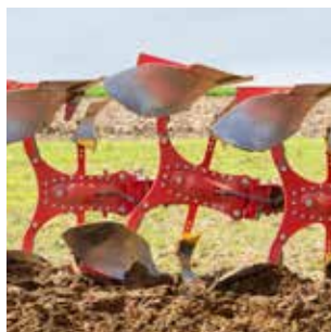
Nonstop jištění těles
