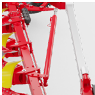
Hydraulicky nastavitelný záběr pluhu
