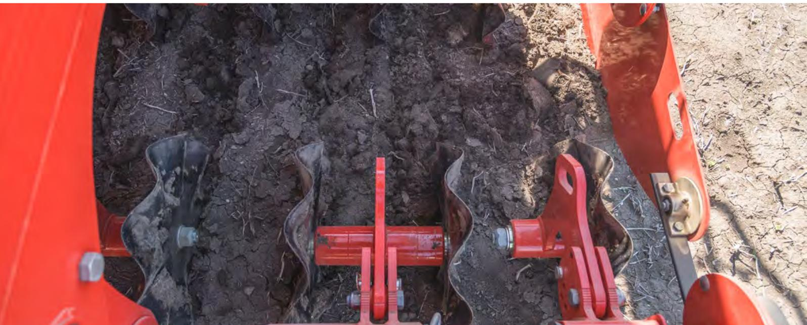
Les disques gaufrés sans entretien WAVE DISC ont un diamètre de 510 mm et sont proposés avec des entre-rangs de 12,5 cm ou 16,7 cm. La profondeur de travail se règle hydrauliquement et en continu. Le principe du WAVE DISC de PÖTTINGER est idéalement adapté aux conditions de travail difficiles, nécessitant un travail du sol restreint. Les WAVE DISC sont proposés sur tous les modèles de TERRASEM.
