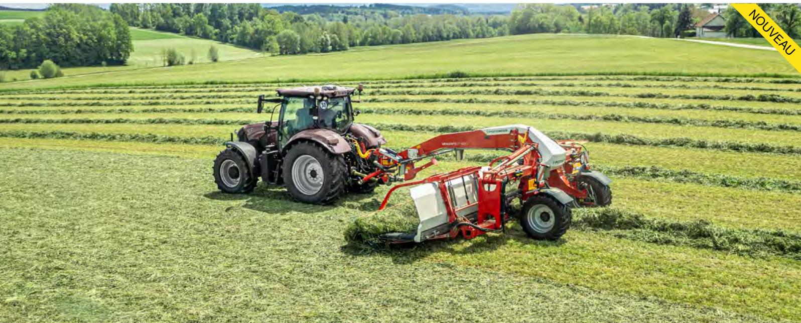
Conçu pour la luzerne et le trèfle, testé dans les différents types de fourrage depuis les prairies permanentes jusqu'à la paille, l'andaineur à tapis de PÖTTINGER garantit une récolte propre de tous les types de fourrage. Le pick-up du MERGENTO prélève le fourrage de la couche végétale. Il est ensuite transporté délicatement par les tapis pour être déposé en andain, sans autre contact avec le sol. La terre et les pierres restent au sol. Les pertes par effeuillement sont réduites au minimum.
