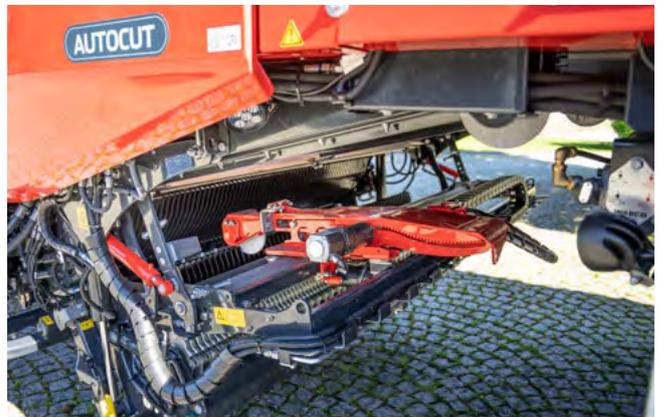
Une coupe nette et régulière est la base pour un ensilage de qualité. Le dispositif AUTO CUT assure une qualité de coupe parfaite tout au long de la journée. Le dispositif d'affûtage automatique AUTO CUT permet d'aiguiser confortablement les couteaux directement sur la remorque.
