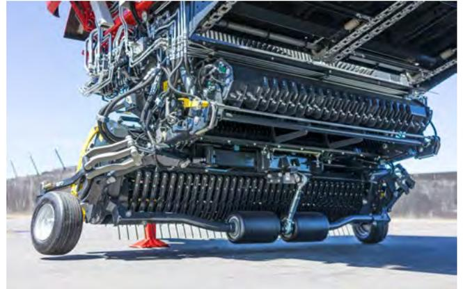
Le nouveau rouleau de jauge est disposé derrière au milieu du pick-up. La position centrale évite la descente du pick-up dans les traces de roues de tracteur et garantit un suivi du sol parfait.
