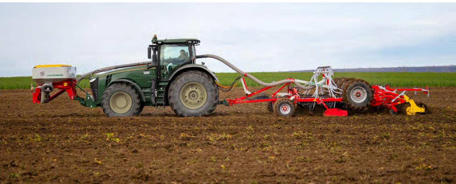
La trémie frontale AMICO offre, en combinaison avec le déchaumeur à dents TERRIA, la possibilité de distribuer de l'engrais, de couverts végétaux ou les deux à la fois. Avec une capacité de 1700 ou 2400 litres et une répartition du volume de 60:40, une large plage d'utilisation est garantie. La trémie peut être équipée au choix d'une ou de deux distributions.
