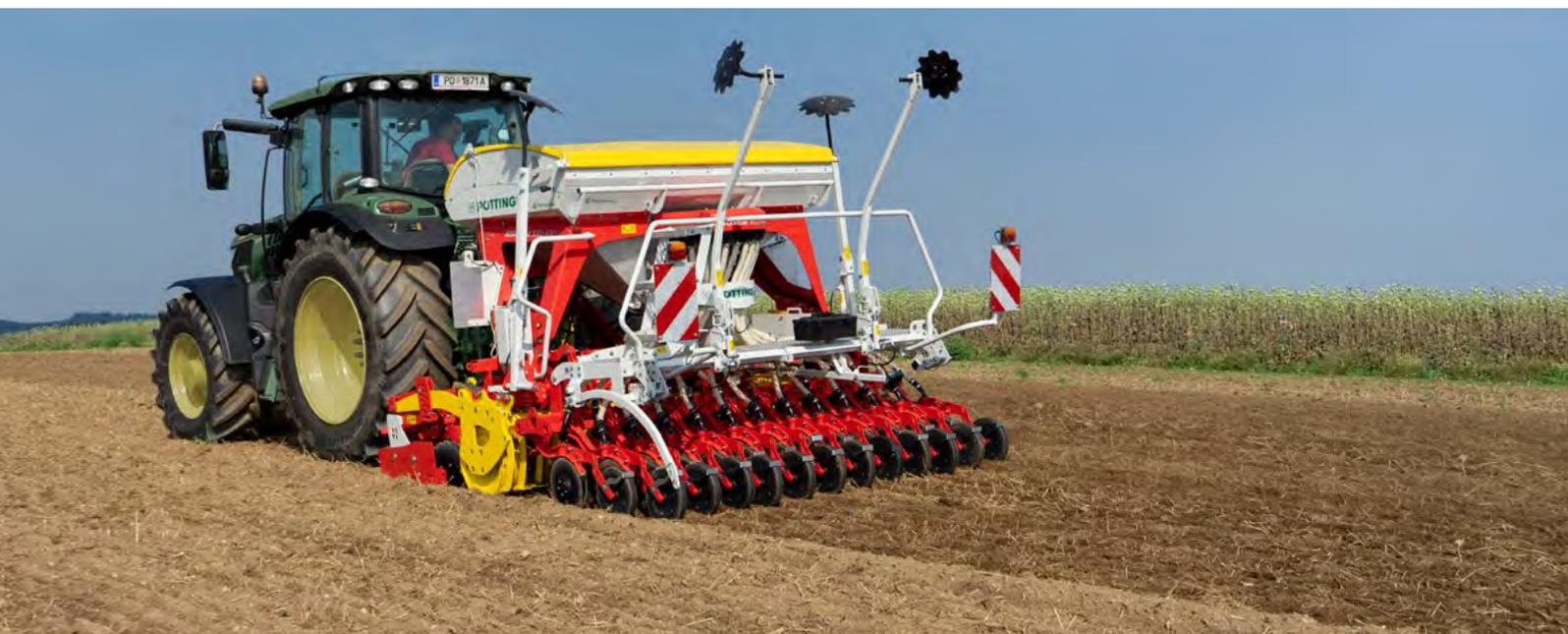
Le concept unique des nouveaux semoirs pneumatiques AROSEM de PÖTTINGER permet à la fois le semis de céréales et le semis monograine du maïs. La distribution précise et universelle ainsi que les éléments de semis performants garantissent une dépose précise de la semence.
