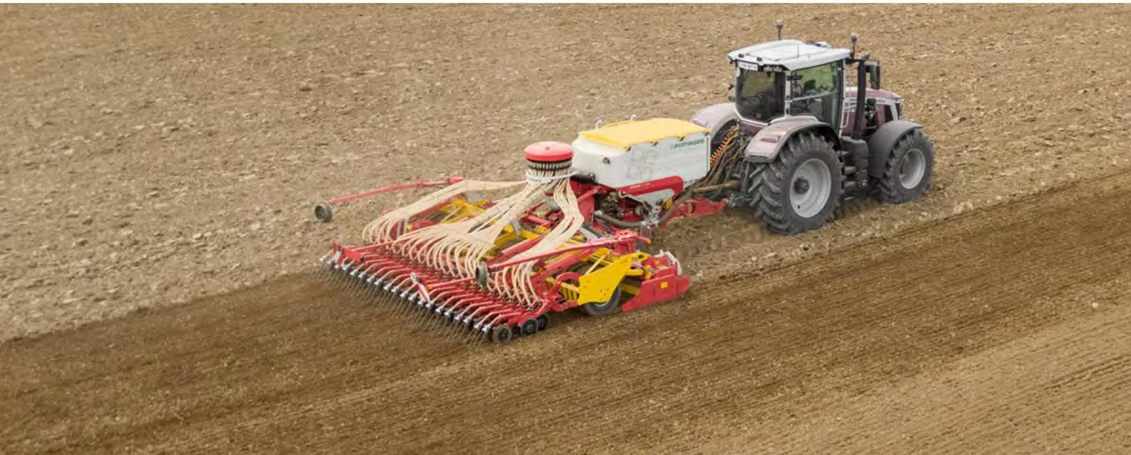
Le nouveau combiné de semis traîné AROSEM VT de PÖTTINGER avec travail du sol actif combine la préparation du lit de semence avec une herse rotative LION, le rappui avec le rouleau à bandes caoutchouc et le semis avec la rampe DUAL DISC. Ce nouveau concept a été conçu aussi bien pour les terres légères qu'extrêmement lourdes.
