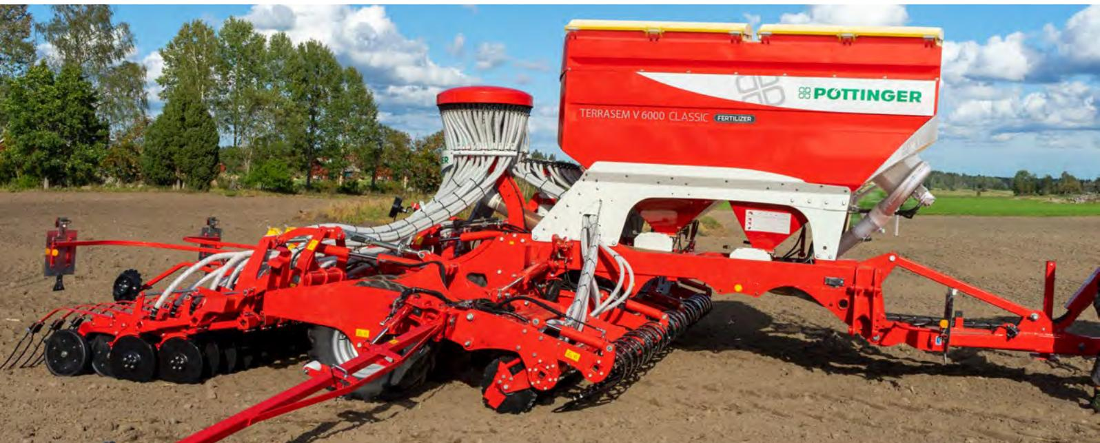
La gamme TERRASEM V CLASSIC sans disques déchaumeurs nécessite moins de puissance pour des performances toutes aussi importantes. Pour cela, le lit de semence doit être bien préparé – cette préparation ayant lieu avant le semis. Grâce à l'adaptation au sol optimale et le rouleau packer à pneu unique en son genre, une dépose parfaite de la semence est réalisée dans un lit de semence parfaitement rappuyé.
