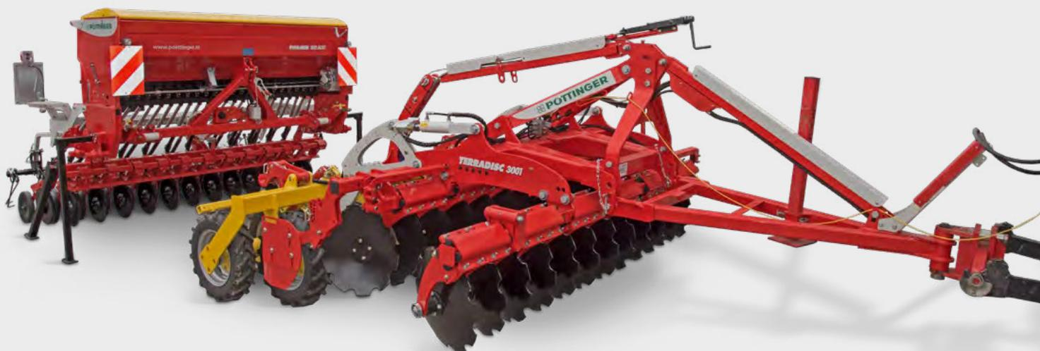
Depuis le déchaumage jusqu'au semis sur mulch avec les semoirs intégrés VITASEM ADD ou AEROSEM ADD. En quelques minutes, le TERRADISC traîné se transforme en un combiné de semis universel performant et économique.
