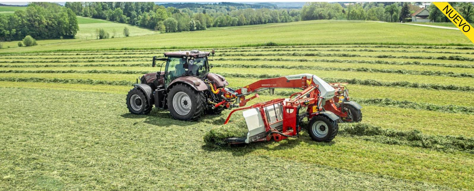
Concebido para alfalfa y trébol, probado en diferentes plantas de cultivo desde forraje permanente hasta paja, el rastrillo de cinta de PÖTTINGER aporta una recogida limpia en todos los tipos de cosecha. MERGENTO recoge el forraje mediante el pick up del suelo. Sin más contacto con el suelo va transportado hacia la hilera de forma cuidadosa mediante las cintas transportadoras transversales y se deposita. La suciedad y las piedras quedan en el suelo. Las pérdidas se reducen al mínimo.
