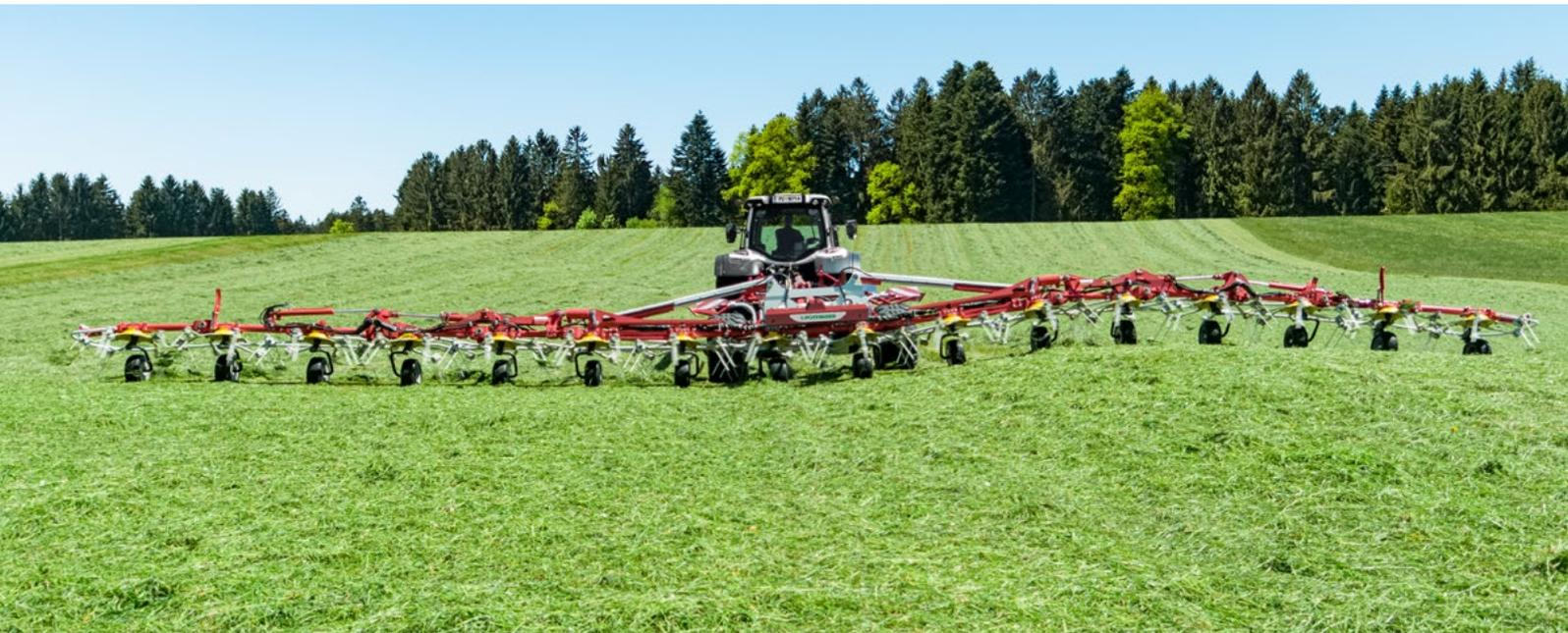
Los rastrillos henificadores se distinguen por su perfecta adaptación al suelo. En los rastrillos henificadores suspendidos y arrastrados, las ruedas palpadoras montadas cerca de la entrada de las púas, reaccionan a cada desnivel. Además las articulaciones del chasis se adaptan de forma independiente a cada contorno. Las púas no tocan el suelo. Esto permite un henificado cuidadoso del forraje sin contaminación.
