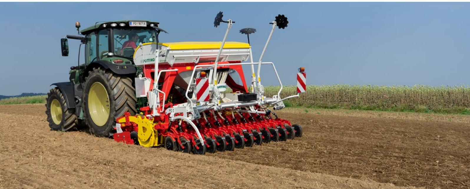
El concepto único de sembradoras AROSEM de PÖTTINGER une la siembra de cereales y maíz. La dosificación de trabajo precisa y universal y los sistemas de reja ampliamente probados garantizan un depósito exacto de la semilla.
