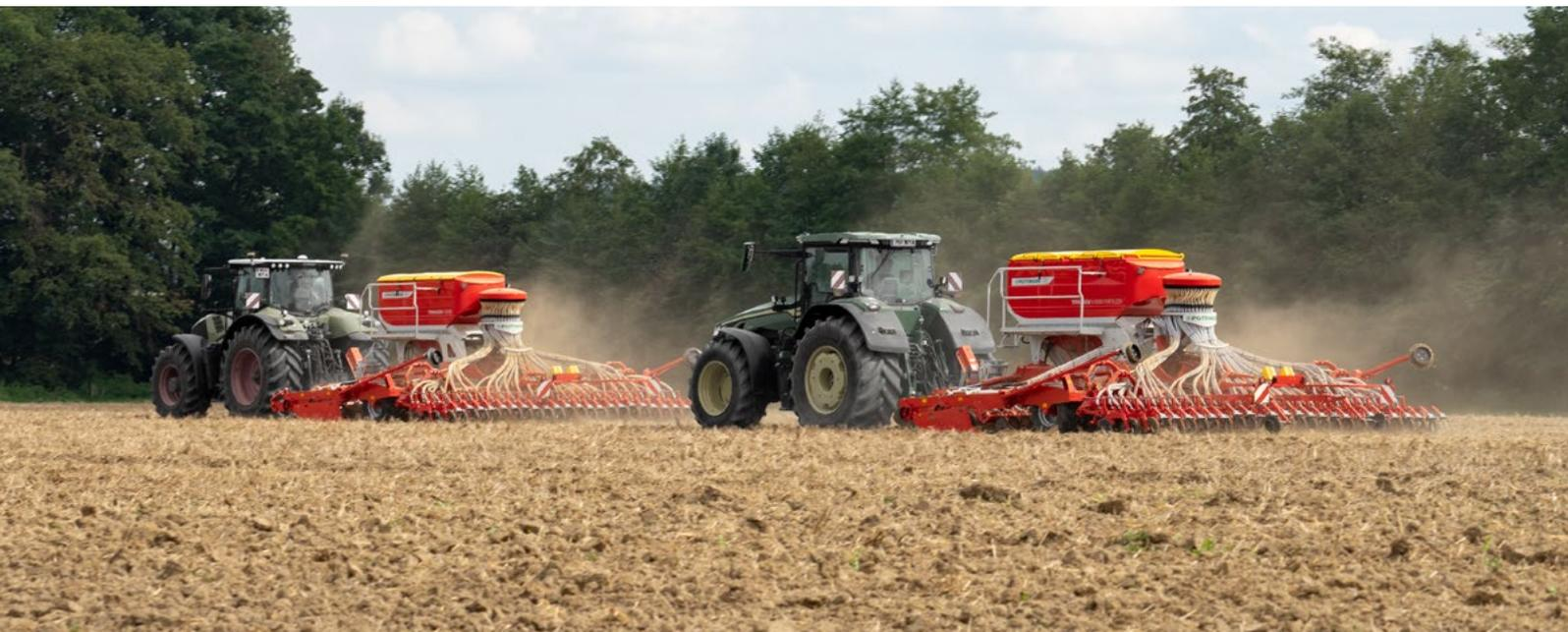
El concepto de mínimo laboreo TERRASEM de PÖTTINGER une los pasos de trabajo de laboreo del suelo, compactación y siembra en una sola máquina: la perfecta combinación de potencia, la máxima seguridad de uso y el depósito preciso de la semilla para sus necesidades.
