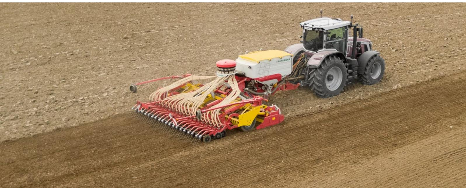
La combinación de siembra arrastrada AEROSEM de nuevo desarrollo con laboreo activo del suelo de PÖTTINGER una la preparación del semillero con la grada rotativa LION, la compactación con el rodillo de hileras y la siembra con la barra de siembra DUAL DISC. El nuevo concepto se desarrolló para tipos de suelos ligeros o más pesados.
