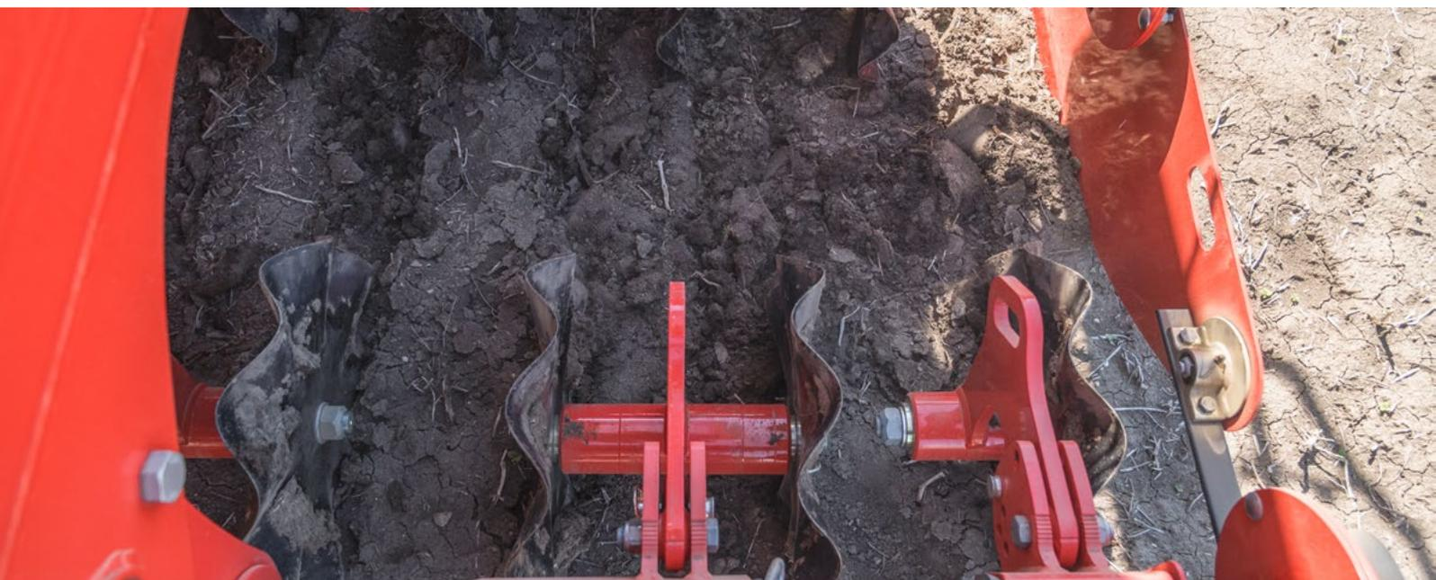
Los discos ondulados WAVE DISC no necesitan mantenimiento, tienen un diámetro de 510 mm y están disponibles con una distancia entre hileras de 12,5 cm o 16,7 cm. La profundidad de trabajo es de ajuste progresivo continuo hidráulico. El sistema WAVE DISC de PÖTTINGER es ideal para condiciones de suelo difíciles, que requieren un laboreo de suelo reducido. Los discos ondulados WAVE DISC están disponibles para todas las sembradoras de mínimo laboreo TERRASEM.
