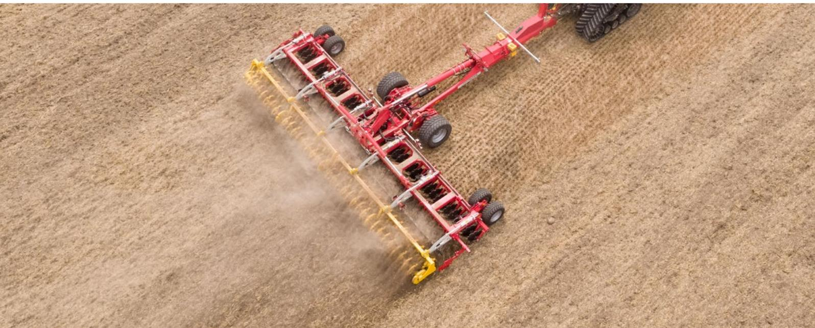
Las gradas de discos cortos TERRADISC se desarrollaron para el volcado de rastrojo y para la preparación general del terreno para la siembra. La construcción compacta, así como la posición agresiva de los discos, aportan una entrada segura y una buena mezcla de los residuos de cosecha.
