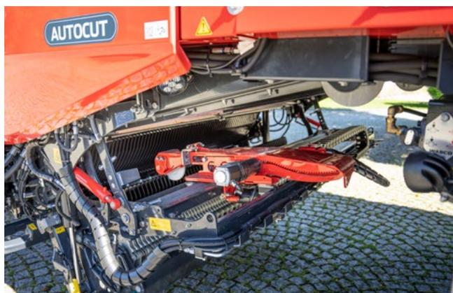
Un corte exacto y uniforme es la base para conseguir la mejor calidad de ensilado. El AUTOCUT asegura una calidad duradera de corte durante todo un día de trabajo. El dispositivo de afilado de cuchillas AUTOCUT permite un cómodo afilado de las cuchillas directamente en el remolque autocargador.
