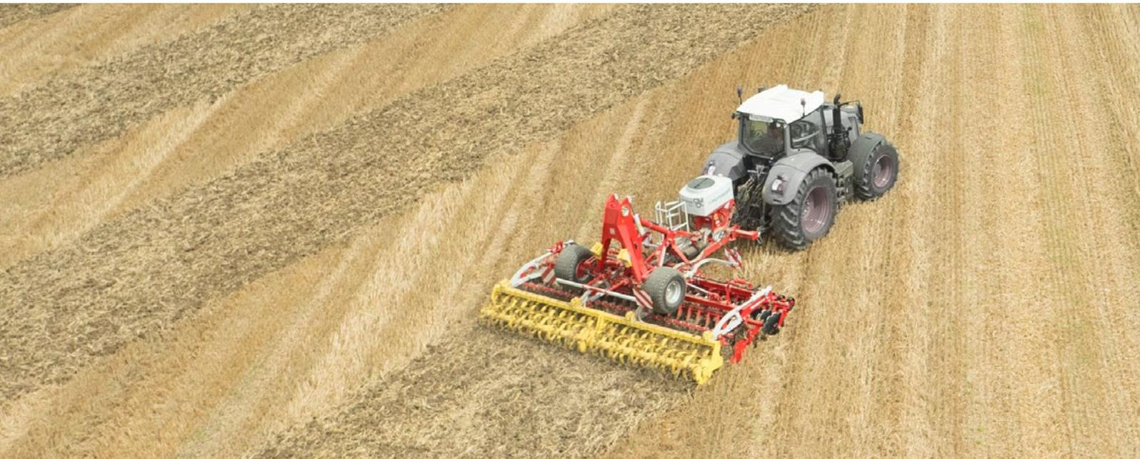
El sistema de siembra de precisión esparcida TEGOSEM combina el laboreo del suelo y la siembra de frutos en una sola pasada, ahorrando tiempo y gastos. La TEGOSEM se puede combinar con las gradas rotativas LION, preparadores de siembra FOX, gradas rápidas TERRADISC, cultivadores SYNKRO así como sembradoras de mínimo laboreo TERRASEM . Es posible usar la sembradora con máquinas suspendidas y arrastradas.
