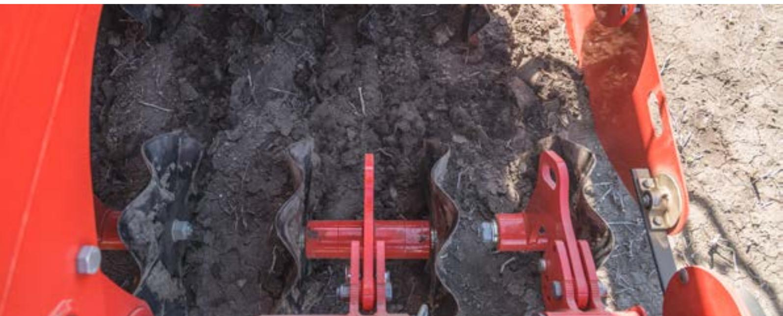
I dischi ondulati WAVE DISC esenti da manutenzione hanno un diametro di 510 mm e sono disponibili con una distanza tra le file di 12,5 cm o 16,7 cm. La profondità di lavoro è regolabile idraulicamente in modo continuo. Il sistema WAVE DISC di PÖTTINGER è perfettamente adatto a condizioni difficili del terreno che richiedono una lavorazione ridotta. I dischi ondulati WAVE DISC sono disponibili per tutte le seminatrici TERRASEM per semina su pacciamme.
