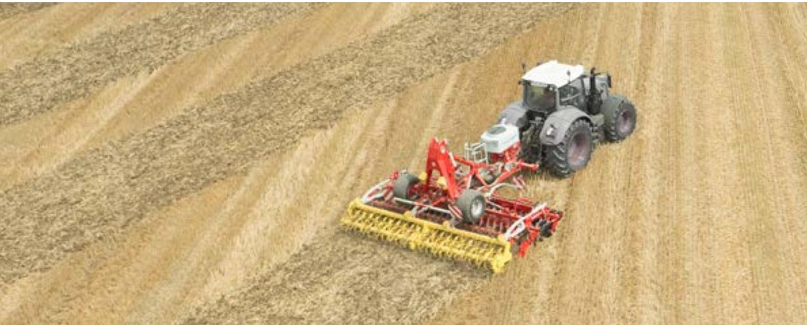
La seminatrice per colture intercalari TEGOSEM combina lavorazione del terreno e semina di colture intercalari in un'unica fase di lavoro, riducendo tempi di lavorazione e costi. TEGOSEM è combinabile sia con gli erpici rotanti LION, che con le combinate FOX, con gli erpici a dischi TERRADISC, con i coltivatori SYNKRO e con le seminatrici per semina su pacciame TERRASEM. L'impiego della seminatrice è possibile con macchine con attacco a 3 punti e con macchine semiportate.
