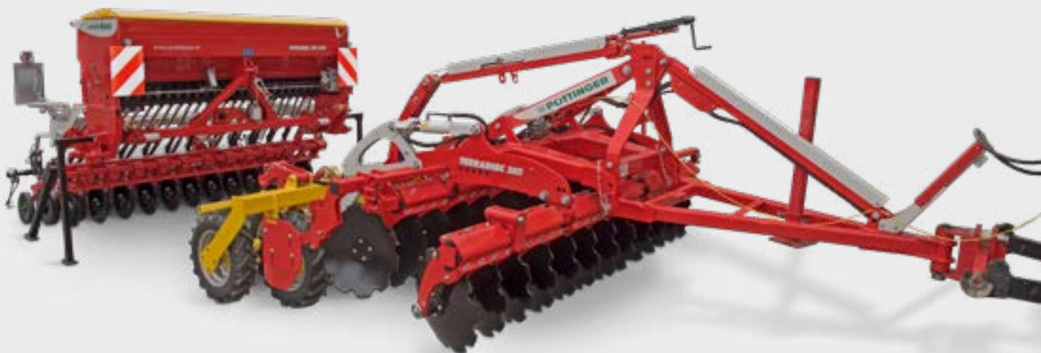
Dall'abbattimento delle stoppie alla semina su pacciame con seminatrici per combinate VITASEM ADD o AEROSEM ADD. In pochi minuti dalla combinazione di un erpice a dischi semiportato TERRADISC con una seminatrice per combinate VITASEM ADD o AEROSEM ADD risulta un'efficiente ed economica macchina per la semina su pacciame.
