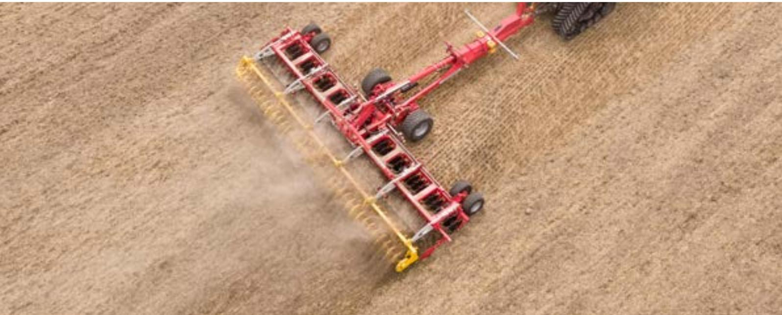
Gli erpici a dischi TERRADISC sono stati concepiti per l'abbattimento delle stoppie e per la preparazione del letto di semina. La costruzione compatta e la posizione aggressiva dei dischi garantiscono una penetrazione efficace ed un buon rimescolamento dei residui colturali.
