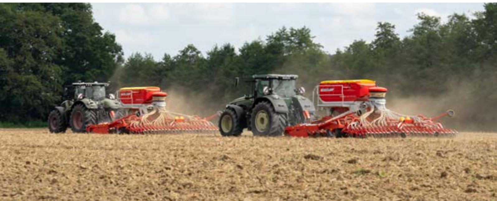
Il progetto delle seminatrici universali TERRASEM di PÖTTINGER riunisce in modo ottimale in una sola macchina diversi processi di lavoro quali lavorazione del terreno, compattazione e semina, rappresentando così una combinazione perfetta tra prestazioni elevate, massima sicurezza d'impiego e deposizione precisa della semente per le vostre esigenze.
