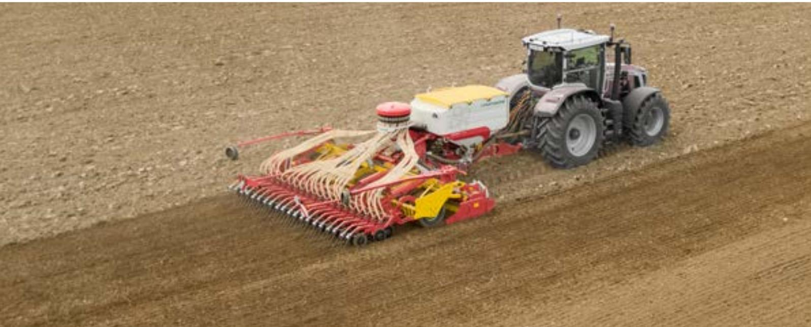
La nuova seminatrice combinata semiportata AEROSEM con lavorazione attiva del terreno di PÖTTINGER combina la preparazione del letto di semina con erpice rotante LION, la compattazione con packer gommato con pneumatici a profilo scanalato e la semina con la barra di semina DUAL DISC. Il nuovo sistema è stato progettato per tipologie di terreno da leggero a molto pesante.
