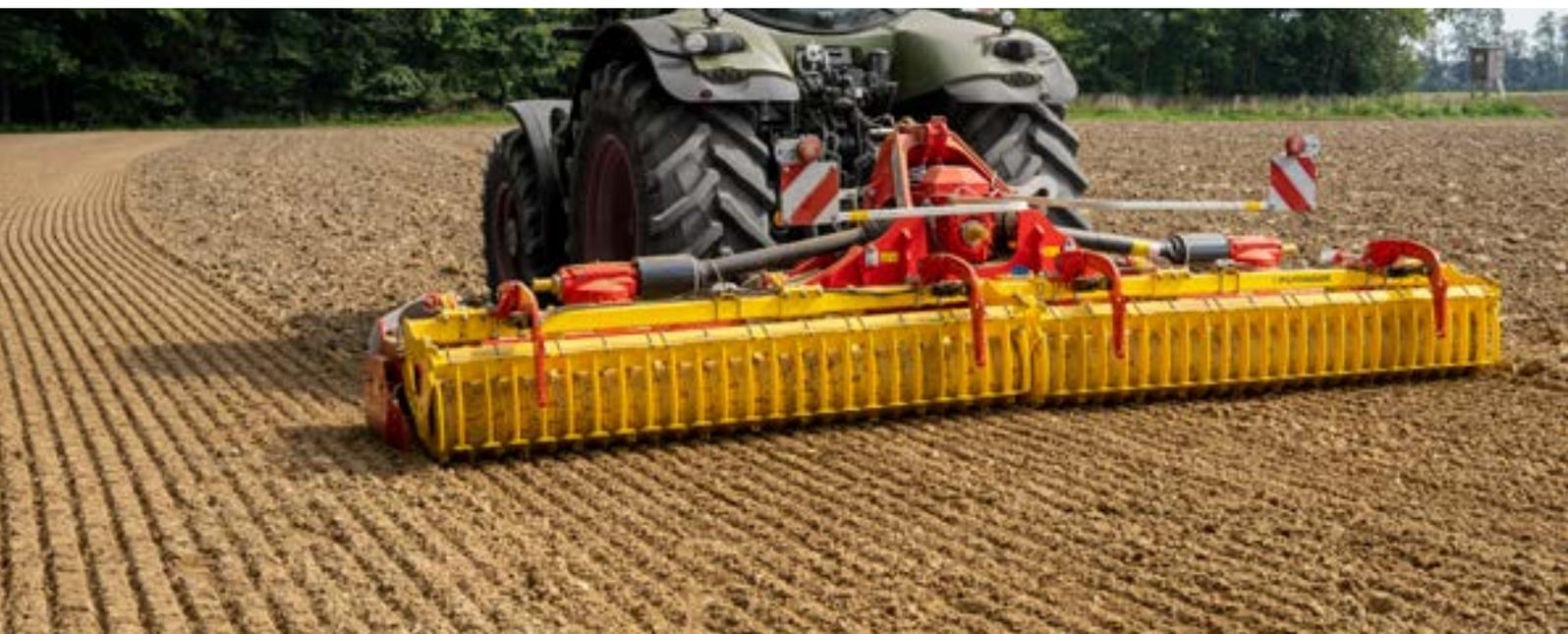
A seconda del tipo di terreno, PÖTTINGER propone una vasta gamma di rulli di trascinamento per una lavorazione ottimale con la struttura di sbriciolamento desiderata. L'intera gamma di rulli si distingue per la lavorazione precisa delle materie prime impiegate e la struttura robusta.
