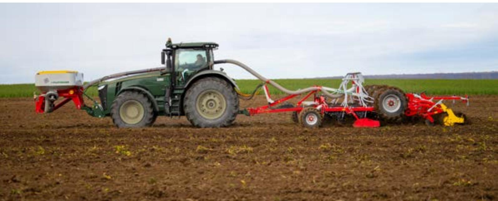
Il contenitore frontale AMICO, in combinazione con i coltivatori TERRIA, offre la possibilità di depositare fertilizzante, colture intercalari oppure entrambi contemporaneamente. Con una capacità di 1.700, risp. 2.400 litri ed una suddivisione del volume del contenitore di 60:40 viene garantito un ampio spettro d'impiego. Il contenitore è disponibile sia con uno che con due dosaggi.
