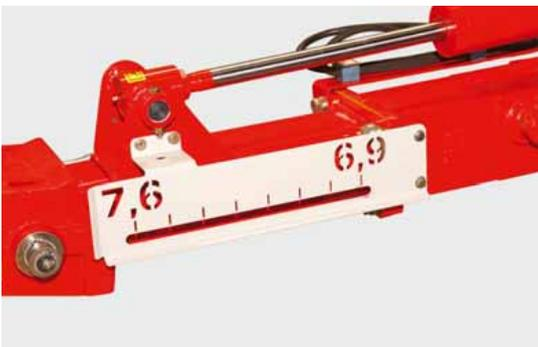
La regolazione idraulica della larghezza di lavoro è una soluzione confortevole per frequenti adattamenti delle andane alle macchine successive. L'indicazione della larghezza di lavoro facilita notevolmente la corretta regolazione.
