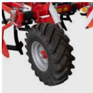
**Ruedas palpadoras hidráulicas (simple) 11.5/80-15.3**
