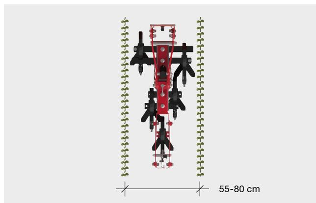
Con cinco herramientas de azada se pueden realizar distancias entre hileras de 55 hasta 80 cm. Así por ejemplo se puede estimular el crecimiento de maíz o girasol. Para anchuras de hileras mayores de 80 cm se puede usar dos elementos de azada por hilera.
