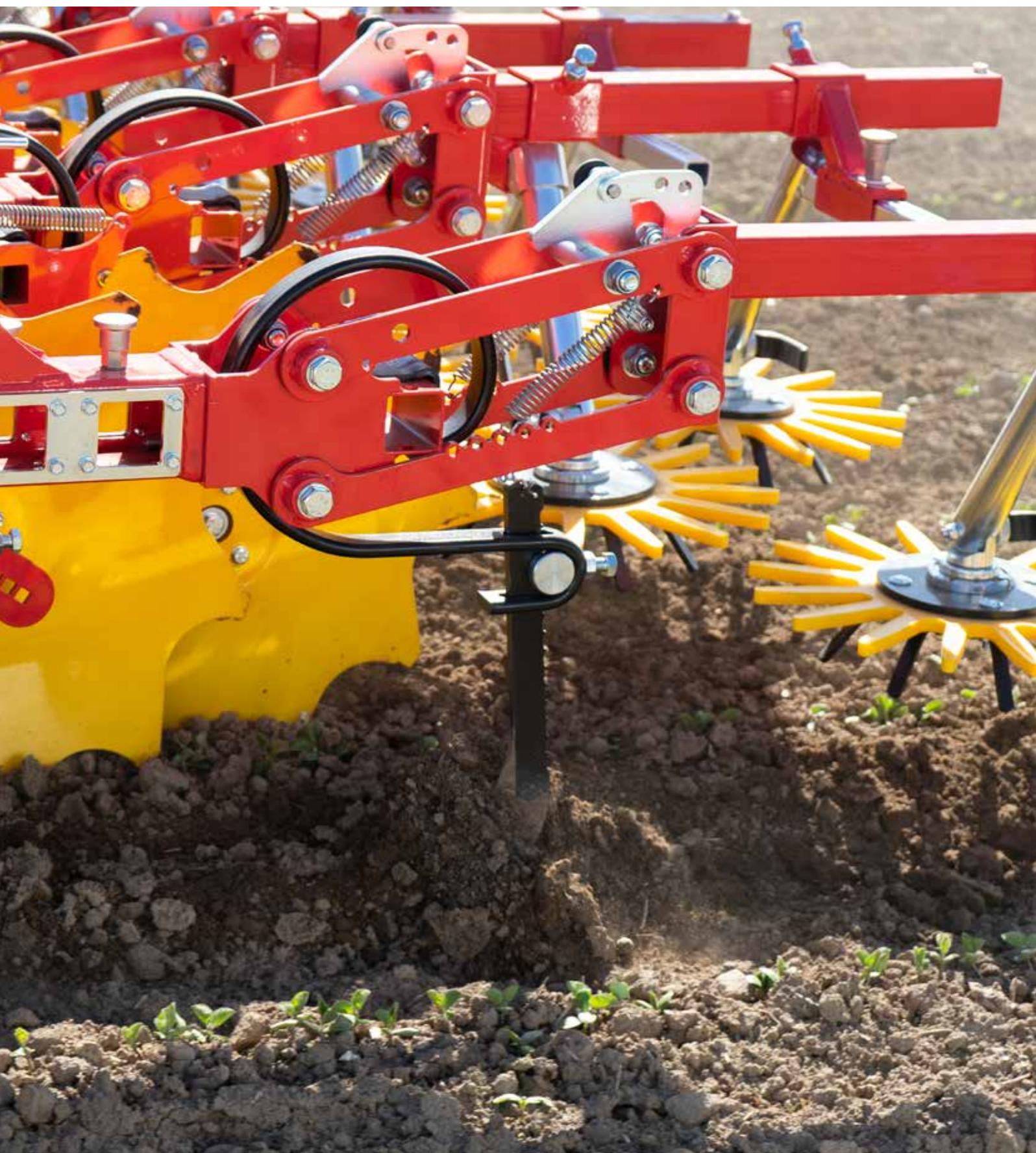
La nueva azada FLEXCARE de PÖTTINGER ofrece, gracias a su concepto único, máxima flexibilidad para el uso en diferentes cultivos. La distancia entre hileras, el ancho de trabajo de los elementos de azada y el ajuste fino de la azada se ajustan sin necesidad de herramientas. Esta máquina se caracteriza por un guiado exacto en profundidad y una manera de trabajar cuidadosa con los cultivos.
