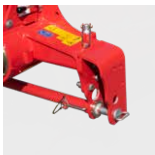
Attacco al trattore Doppi cuscinetti a rulli nell'attacco
