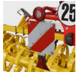
Waarschuwingsborden en verlichting
