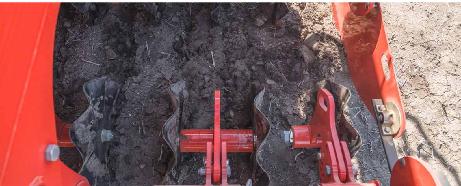
I dischi ondulati WAVE DISC, esenti da manutenzione, hanno un diametro di 510 mm e sono disponibili con una distanza tra le file di 12,5 cm o 16,7 cm. La profondità di lavoro è regolabile idraulicamente in modo continuo. Il sistema WAVE DISC di PÖTTINGER è perfettamente adatto a condizioni difficili del terreno che richiedono una lavorazione ridotta. I dischi ondulati WAVE DISC sono disponibili per tutte le seminatrici TERRASEM per semina su paccame.
