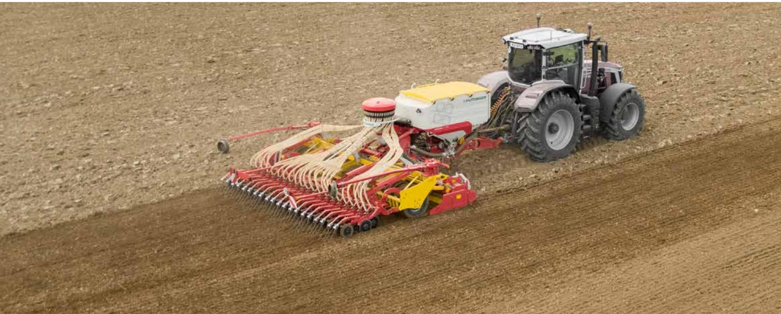
Le seminatrici combinate AEROSEM con lavorazione attiva del terreno combinano la preparazione del letto di semina con erpice rotante LION, la compattazione con Packer gommato con pneumatici a profilo scanalato e la semina con la barra di semina DUAL DISC. Il sistema è stato progettato per tipologie di terreno da leggero ad estremamente pesante.
