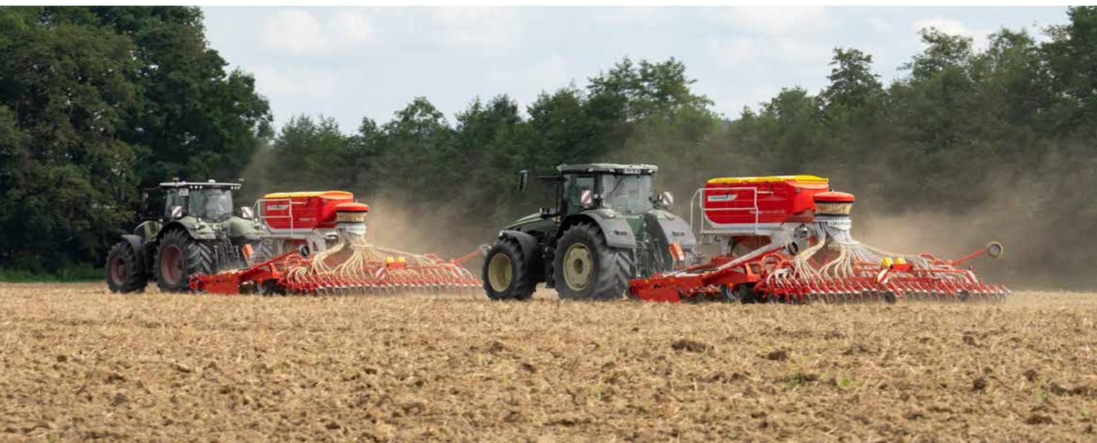
Il progetto delle seminatrici universali TERRASEM riunisce in una sola macchina i processi di lavoro di lavorazione del terreno, compattazione e semina, rappresentando così una combinazione perfetta tra prestazioni elevate, massima sicurezza d'impiego e deposizione precisa della semente per le vostre esigenze.
