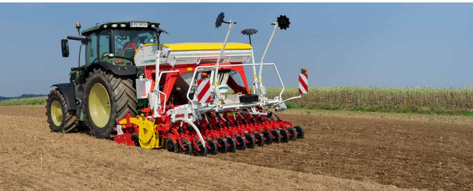
L'eccezionale tecnologia della seminatrice AEROSEM combina la semina di cereali e di mais. Il preciso sistema di dosaggio universale ed il pluri-affermato sistema di coltri garantiscono un deposito preciso della semente.
