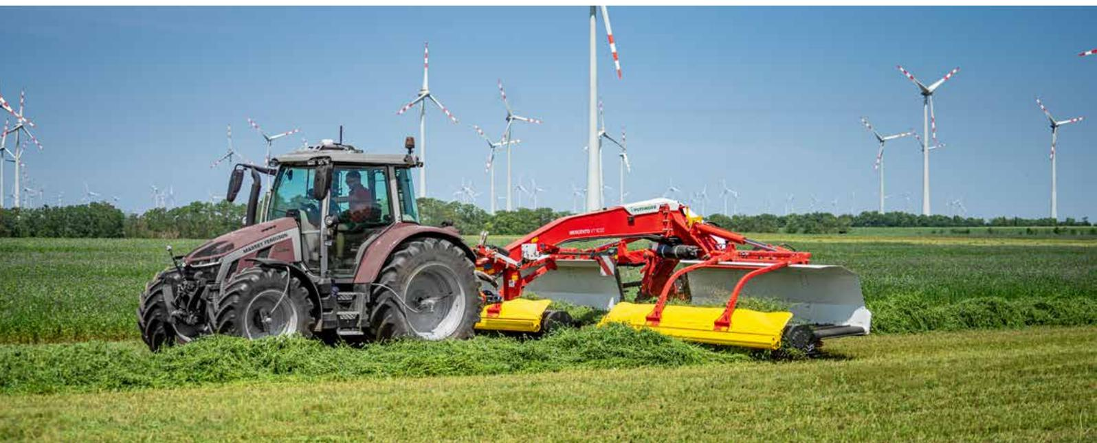
MERGENTO raccoglie il foraggio dal terreno con il pick-up. Senza ulteriore contatto con il terreno, il foraggio viene trasportato delicatamente verso l'andana tramite i nastri trasportatori trasversali e depositato lì. Sporizia e sassi restano sul terreno. Le perdite per sbriciolamento vengono ridotte al minimo.
