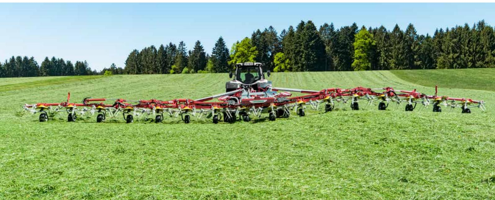
I nostri affermati spandivoltafieno convincono per il loro adattamento perfetto al terreno. Sia negli spandivoltafieno portati che in quelli semiportati e trainati, le ruote tastatrici montate davanti ai denti in presa reagiscono a qualsiasi irregolarità del terreno. Inoltre tutti i giunti del telaio si adattano in modo indipendente uno dall'altro alla conformazione del terreno. I denti non toccano il terreno. Ciò consente un rivoltamento del foraggio senza sporco.
