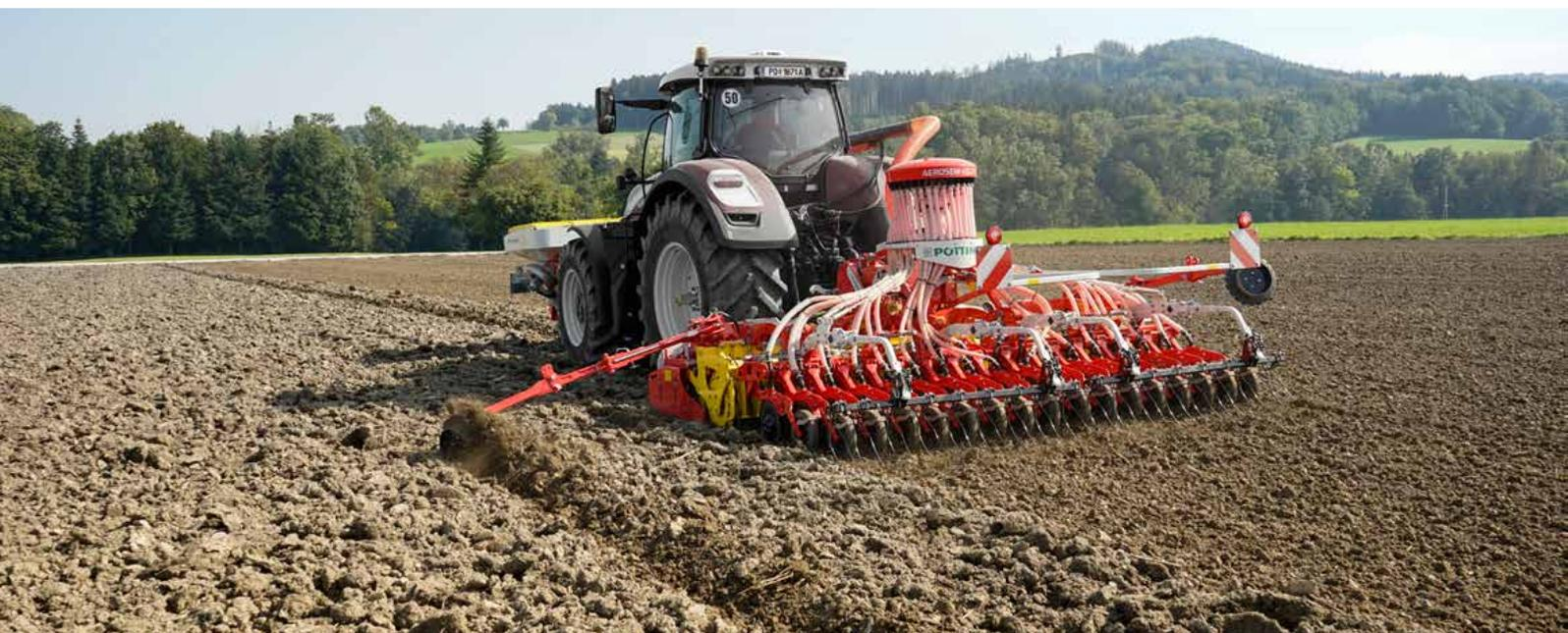
PÖTTINGER con la seminatrice con contenitore frontale AEROSEM FDD amplia la sua gamma di seminatrici pneumatiche per combinate con macchine con larghezza di lavoro fino a 6 m.
