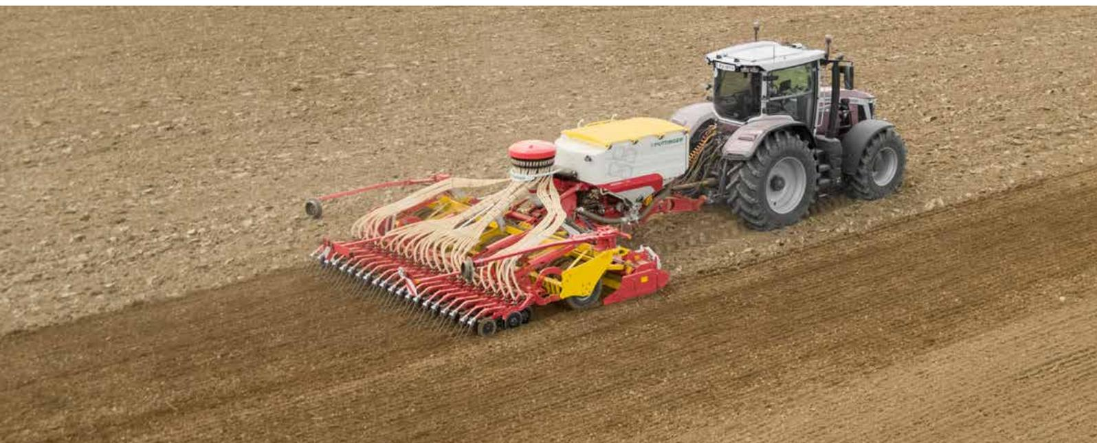
Прицепные посевные комбинации AEROSEM с активной обработкой почвы сочетают в себе подготовку посевного ложа с помощью ротационной бороны LION, обратное уплотнение с помощью почвоуплотнителя с рифлеными шинами и посев с помощью высевальной балки DUAL DISC. Концепция прицепных сеялок была разработана для эксплуатации на любых типах почв : от лёгких и до самых тяжелых.
