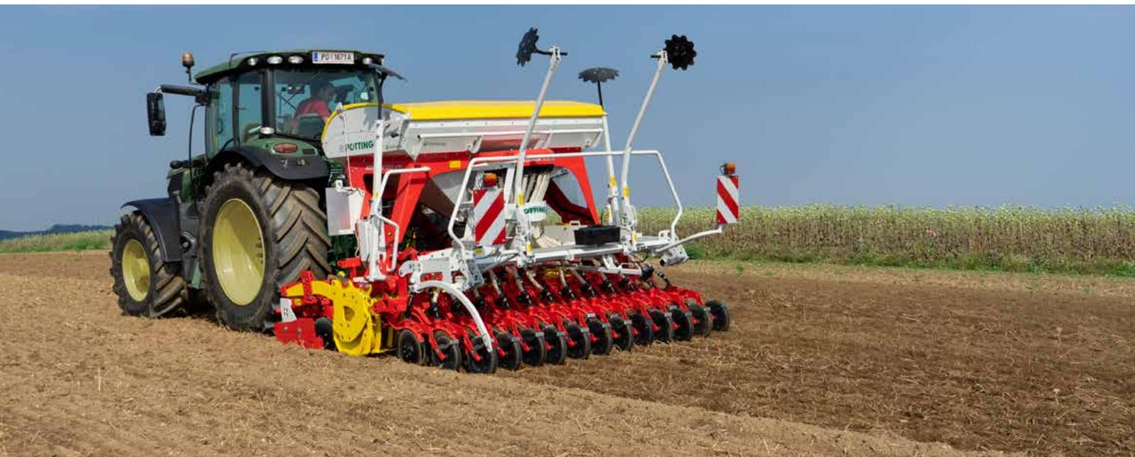
Инновационная концепция сеялок AEROSEM объединяет посев зерновых культур и кукурузы. Точные, универсальные технологии дозирования и надежная система сошников гарантируют оптимальную заделку посевного материала.
