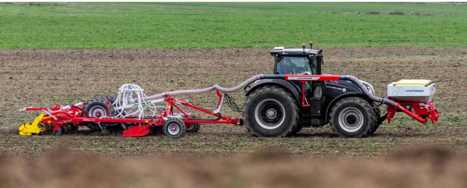
Фронтальный бак AMICO F в сочетании с различными сельскохозяйственными машинами дает возможность одновременного внесения удобрений или микрогранул, промежуточных культур или двух компонентов. Благодаря емкости 1 700 или 2 400 л и соотношению объемов 60:40 обеспечивается широкая область применения.
