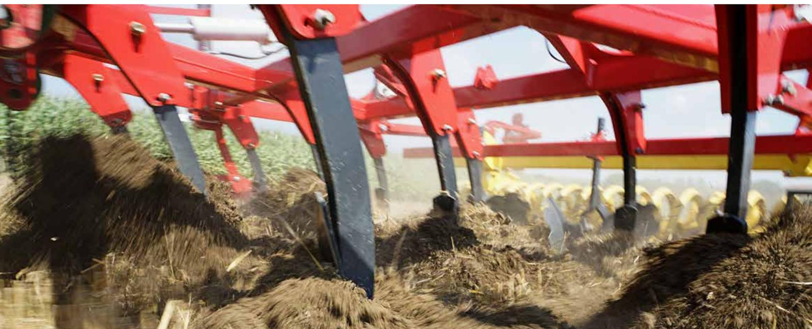
Культиваторы SYNKRO компании PÖTTINGER разработаны для своевременной обработки стерни и подходят как для поверхностной, так и для глубокой обработки почвы. При их конструировании особое внимание уделялось достижению легкости хода при незначительной требуемой мощности.
