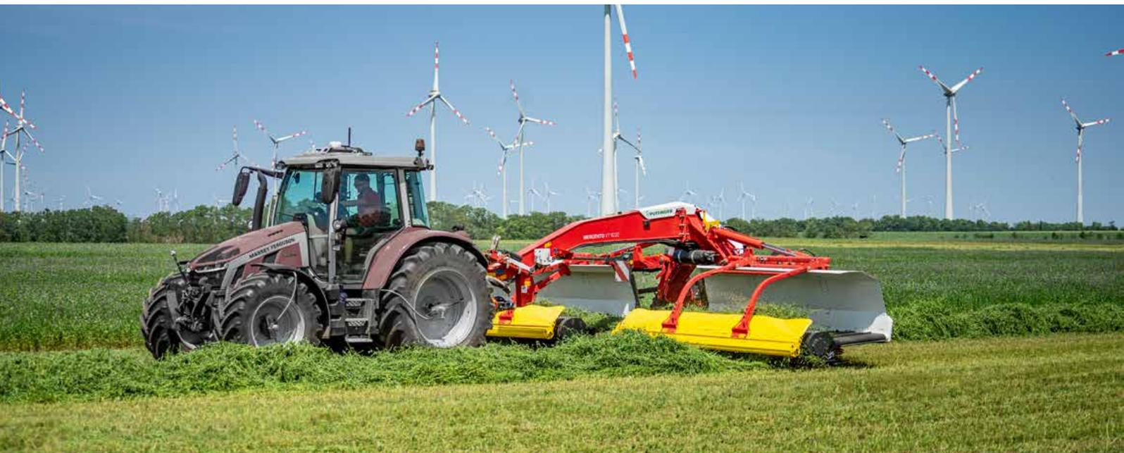
MERGENTO собирает корм с земли с помощью подборщика. Не контактируя с землей, он аккуратно перемещается по поперечным ленточным транспортерам в направлении валка и укладывается там. Грязь и камни остаются на земле. Потери скошенной массы снижаются до минимума.
