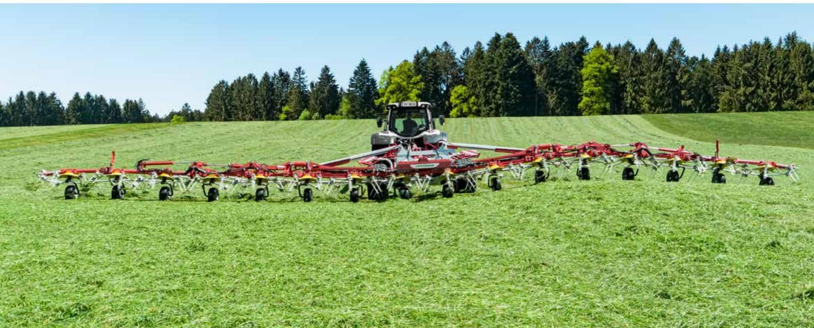
Хорошо зарекомендовавшие себя роторные ворошилки PÖTTINGER идеально копируют поверхность поля. Как на навесных, так и на прицепных ворошилках расположенные близко к граблям копирующие колеса реагируют на каждую неровность поля. Кроме того, все соединения рамы адаптируются к контуру поля независимо друг от друга. Граблины не касаются земли. Это способствует более щадящему процессу ворошения и уменьшает попадание грязи в корм.
