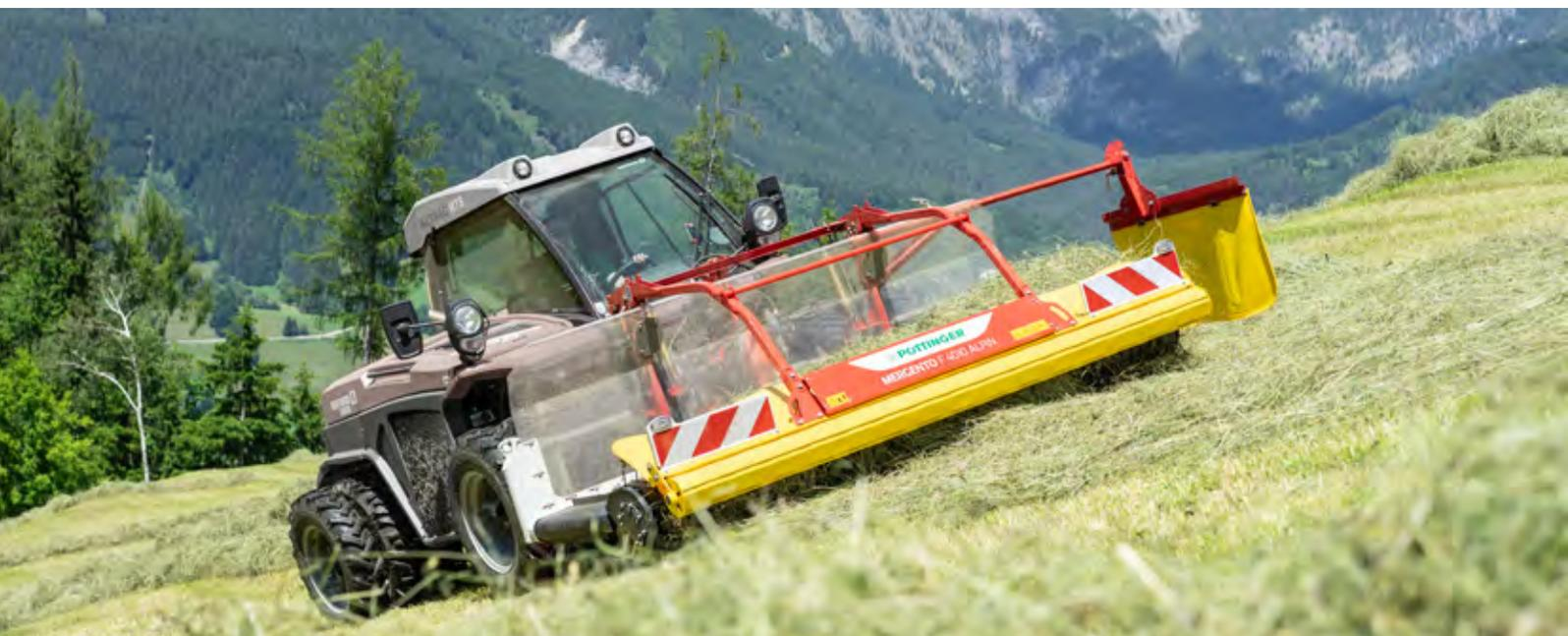
Il pick-up guidato di PÖTTINGER a 4 file di denti garantisce una raccolta pulita del foraggio. Il foraggio viene raccolto delicatamente dal terreno grazie ai denti del pick-up guidati a strascico e convogliato velocemente in modo mirato verso il nastro trasportatore trasversale.
