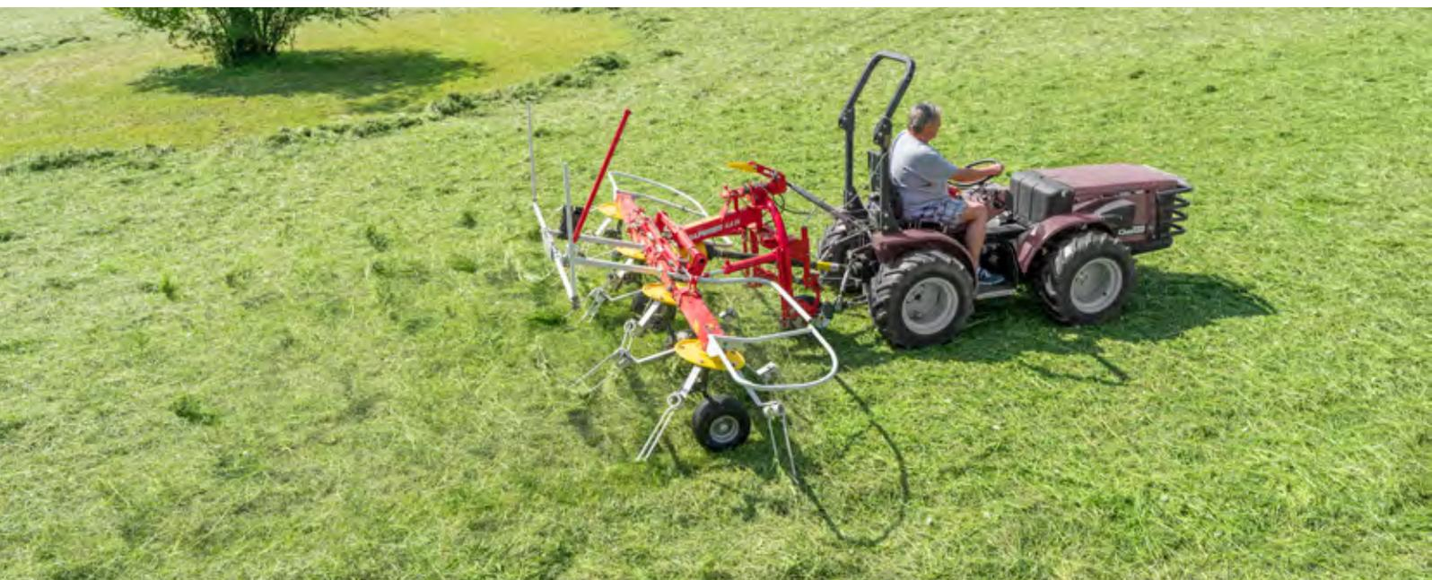
I due modelli ALPINHIT a 4 giranti sono dei veri e propri pesi leggeri. A seconda del modello, lo spandivoltafieno con attacco a 3 punti fisso (ALPINHIT 4.4 H) pesa solo 285 kg. Il modello con cavalletto sterzante (ALPINHIT 4.4 N) pesa solo 330 kg. Entrambi gli spandivoltafieno raggiungono una larghezza di lavoro (DIN) di 4,0 m.
