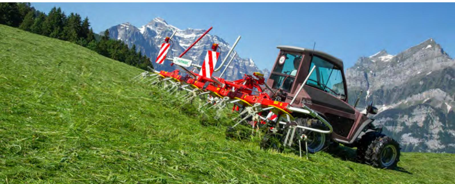
Nello spandivoltafieno ALPINHIT 6.6 leggerezza e perfetto adattamento al terreno sono prioritari. Con una larghezza di lavoro (DIN) di 5,75 m ed un peso di soli 564 kg è un peso leggero molto efficiente. ALPINHIT 6.6 è dotato di serie di un cavalletto sterzante e di aste ammortizzatrici meccaniche. A fine campo LIFTMATIC o HYDROLIFT, disponibili entrambi su richiesta, garantiscono una sufficiente libertà dal suolo.
