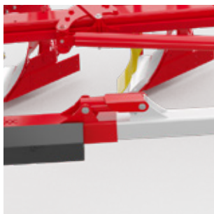
Гидравлическая настройка ширины захвата первого корпуса
