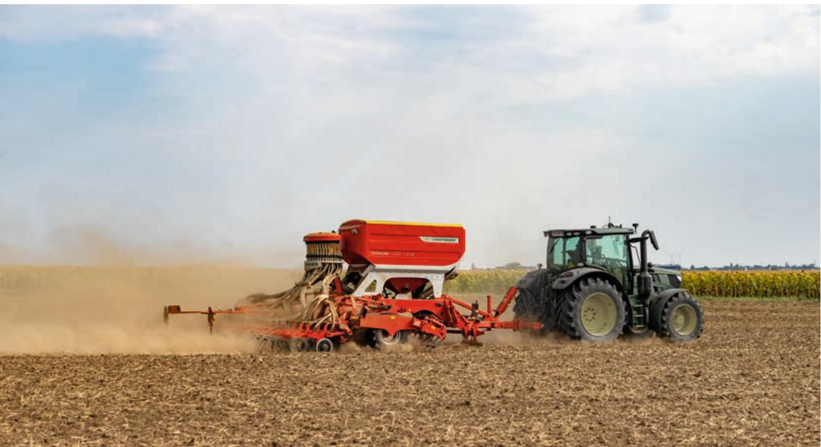
Utůžení půdy zabezpečuje osvědčený pneumatikový válec podvozku. Nutností je zpětné utůžení lůžka, aby byl zajištěný vzestup kapilární vody a osivo dosáhlo potřebné klíčivé vlhkosti.
