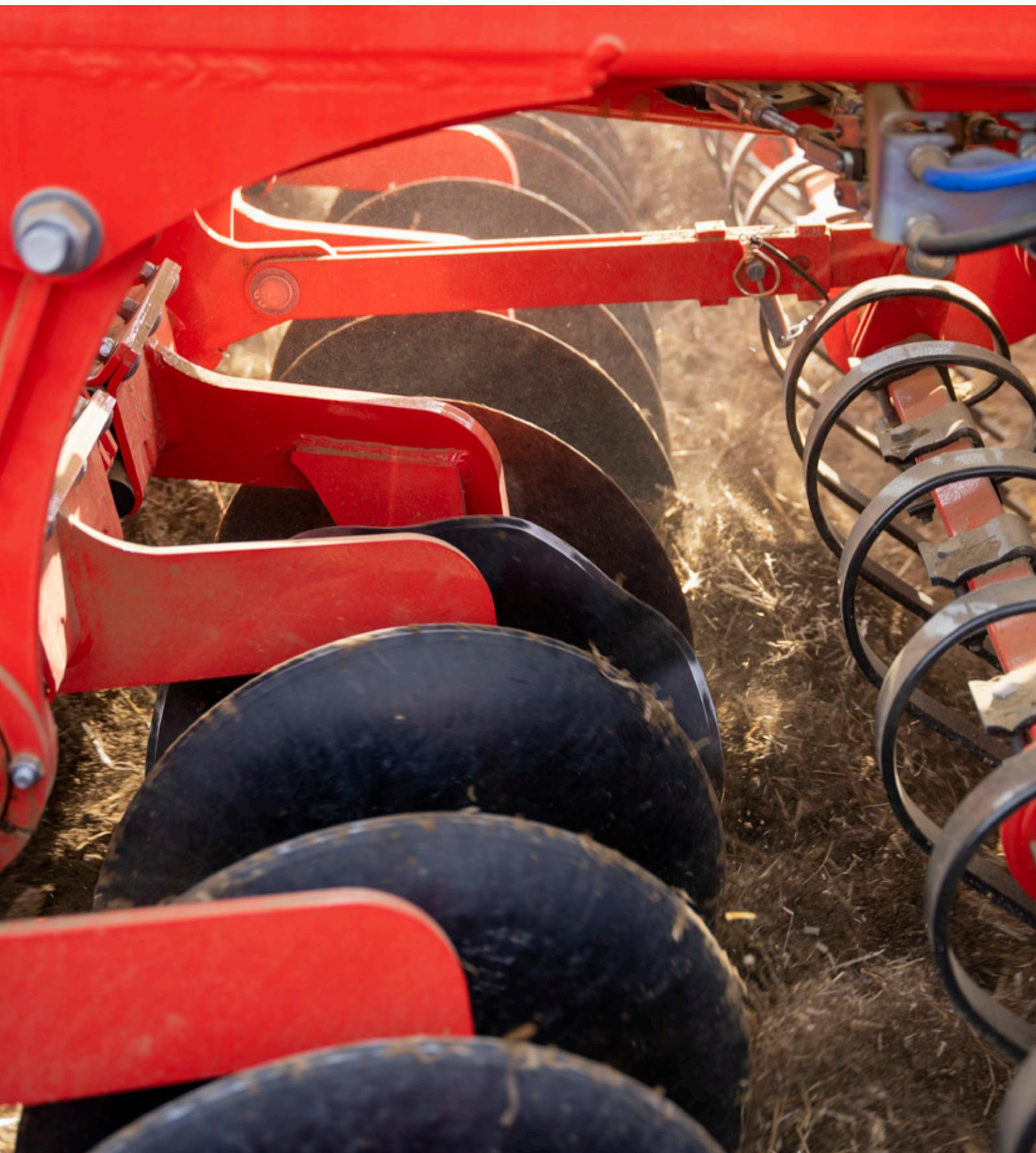
Půdní podmínky a vlivy počasí určují výběr vhodné technologie při zakládání porostů. Koncept secích strojů TERRASEM firmy PÖTTINGER kombinuje pracovní kroky přípravy seťového lůžka s opětovným utužením a setí při jednom přejezdu. Dokonalé sladění efektivity a přesného uložení osiva dle Vašich potřeb.
