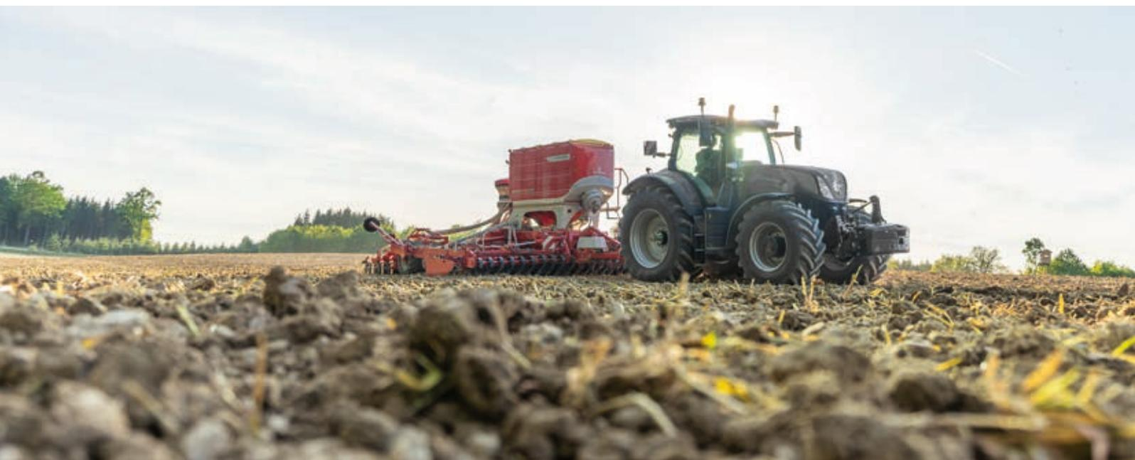
Profiline představuje komfortní ovládání všech hydraulických funkcí TERRASEM. Stroj je zásobován olejem pouze systémem Load Sensing traktoru a veškeré nářadí je ovládáno elektrohydraulicky přes hydraulický blok. Ovládá se stisknutím tlačítka na terminálu nebo automaticky pomocí Task Controller.
