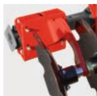
**Nastavitelné disky stop kol traktoru**
