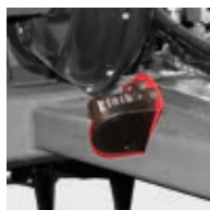
Sensor radar para dosificación
