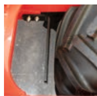
Décrottoirs de roues pneus
