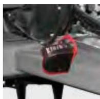
**Sensore radar per dosaggio**
