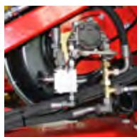
**Azionamento idraulico ventola con Load-Sensing**
