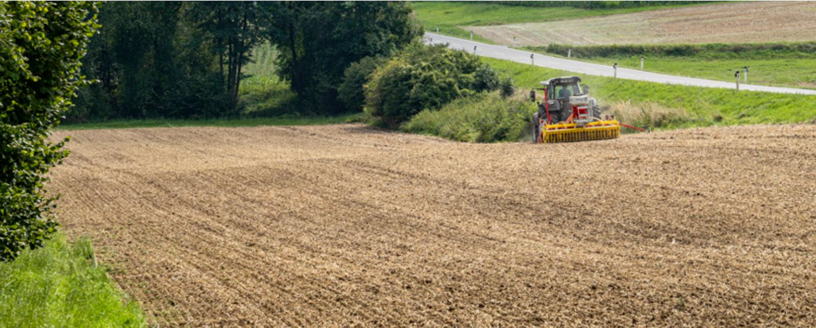
Le semoir pour couverts végétaux TEGOSEM permet de combiner le travail du sol et la distribution d'un engrais ou le semis d'un couvert végétal en un seul passage pour une économie de temps et d'argent. Le TEGOSEM peut être combiné avec des machines portées ou traînées.
