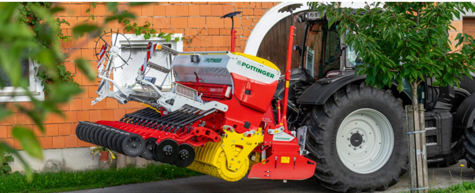
Nos herse rotatives fixes sont disponibles en trois gammes différentes : la principale différence réside dans le dimensionnement des composants et des roulements des différents boîtiers et lamiers, pour s'adapter aux différentes puissances de tracteur. Tous ont en commun les possibilités de réglage pour obtenir un résultat de travail parfait.
