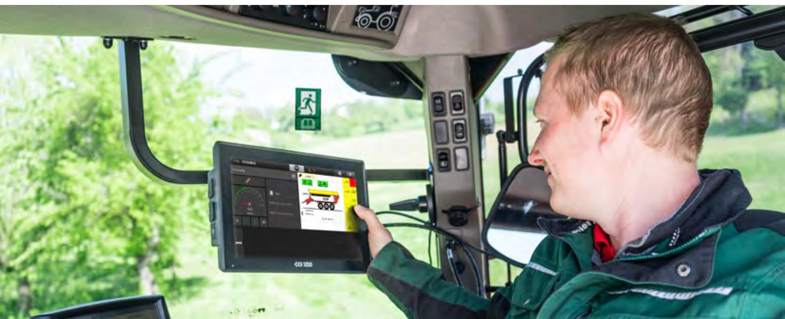
CCI 1200 - un terminal pour toutes les machines compatibles ISOBUS. Le grand écran et l'agencement flexible des machines, de la caméra et du contrôle de section permettent de s'amuser toute la saison.
